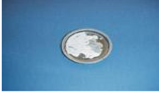
Şekil 3.19. Buharlaştırma işlemi sonunda içerisinde tortu (rezidü) bulunan planşet örneği
