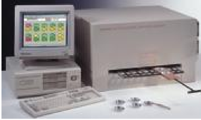
Şekil 3.14. LB 770 10 kanallı düşük seviyeli planşet sayıcısı (Berthold)
