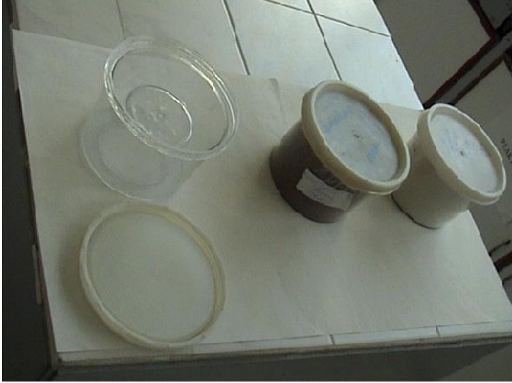
Şekil 3.16. Boş ve doldurulup, tartılıp etiketlenmiş ve ağız kısmı kapatılmış (seal edilmiş) marinelli kapları (ÇNAEM Laboratuvarı)
