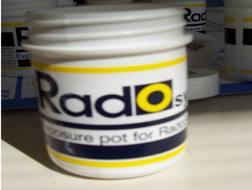
Şekil 3.15. CR – 39 Radon dedektörü (ÇNAEM Laboratuvarı)
