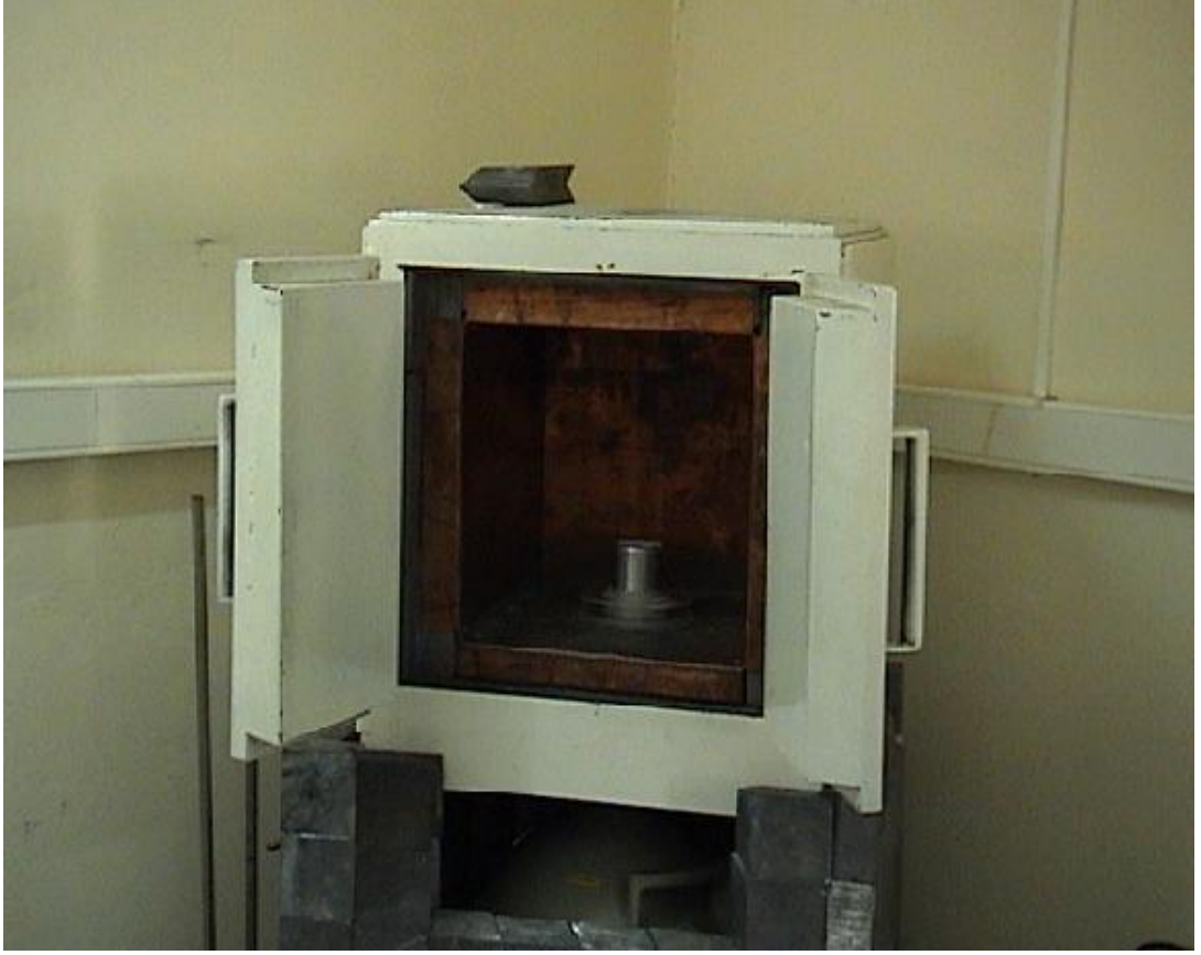
Şekil 3.8. Saf Germanyum dedektörlü gama spektrometrik cihazının çalışma düzeneği (ÇNAEM laboratuvarı )
