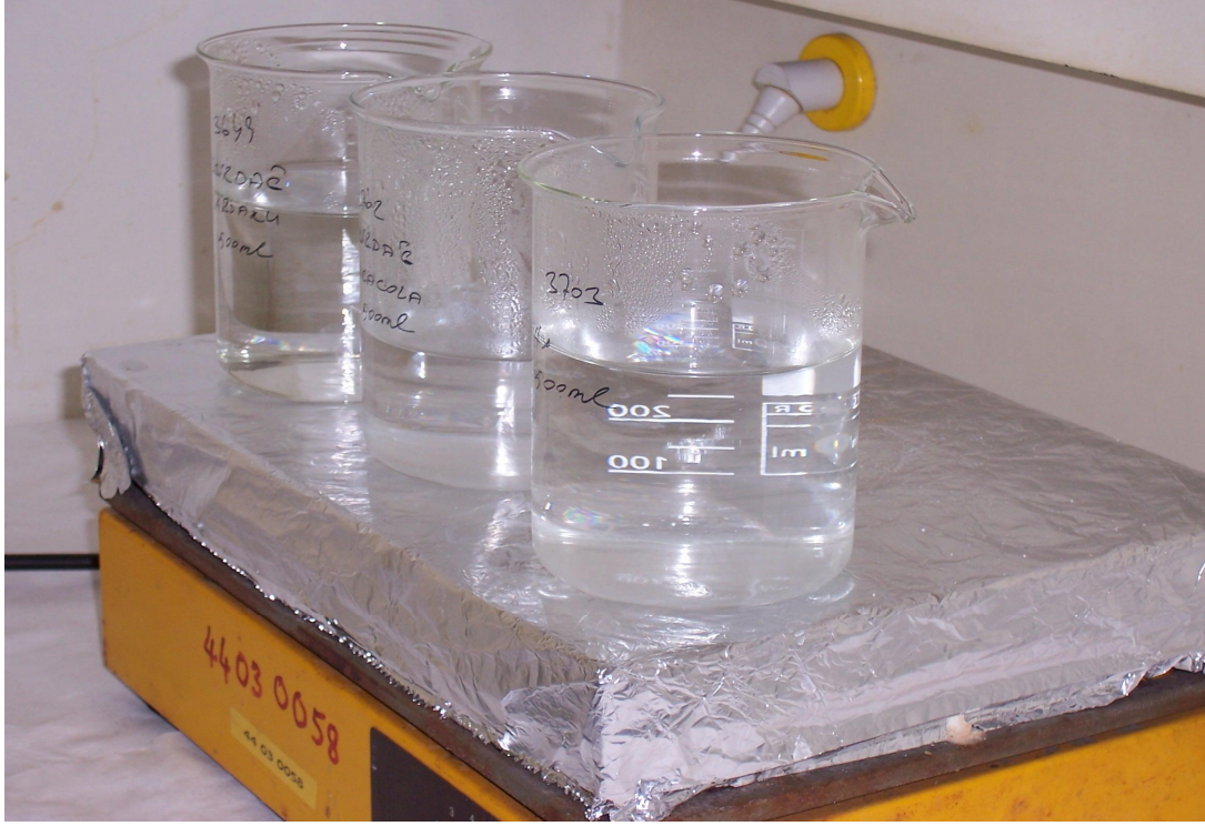
Şekil 3.17. Beher kaplarındaki su örneklerinin buharlaştırma işlemi (ÇNAEM Laboratuvarı)
