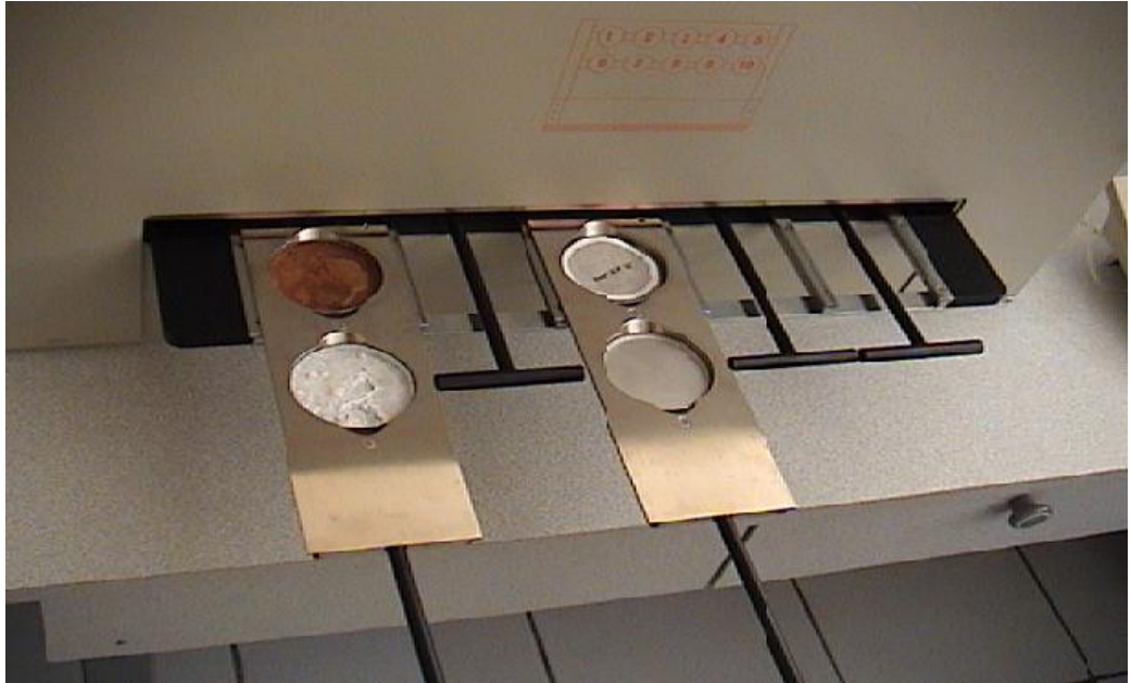
Şekil 3.20. LB-770 alfa-beta sayım sistemi (ÇNAEM laboratuvarı)
