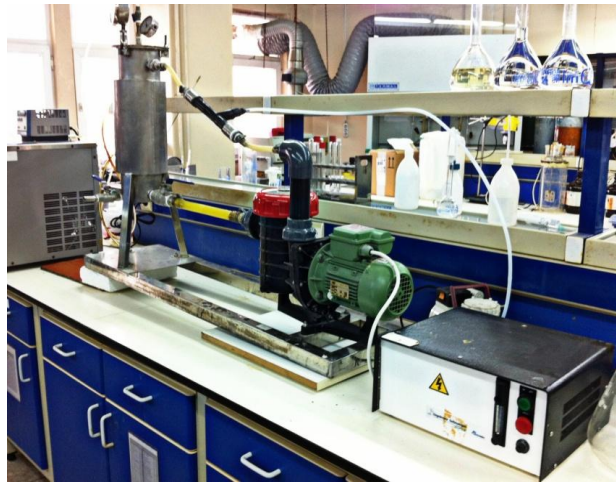
Şekil 3.12: Ozon reaktörü ve soğutma ünitesi
