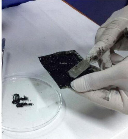
Şekil 3.10: Membran yüzeyinden ekstrasyon için çamur sıyırılması
