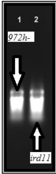
Şekil 4.1: Total RNA izolasyonlarının agaroz jel elektroforezi. 1) S. pombe 972h yabani ırk; 2) S. pombe ird11 .
