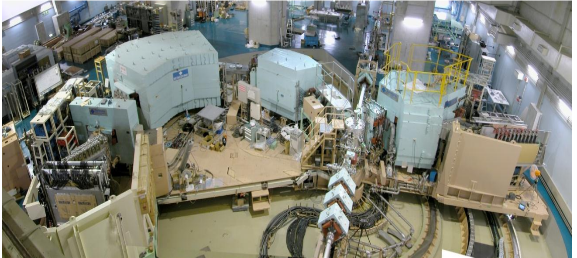
Şekil 3.6:RCNP merkezindeki Grand Raiden spektrometresinin genel görünümü.
