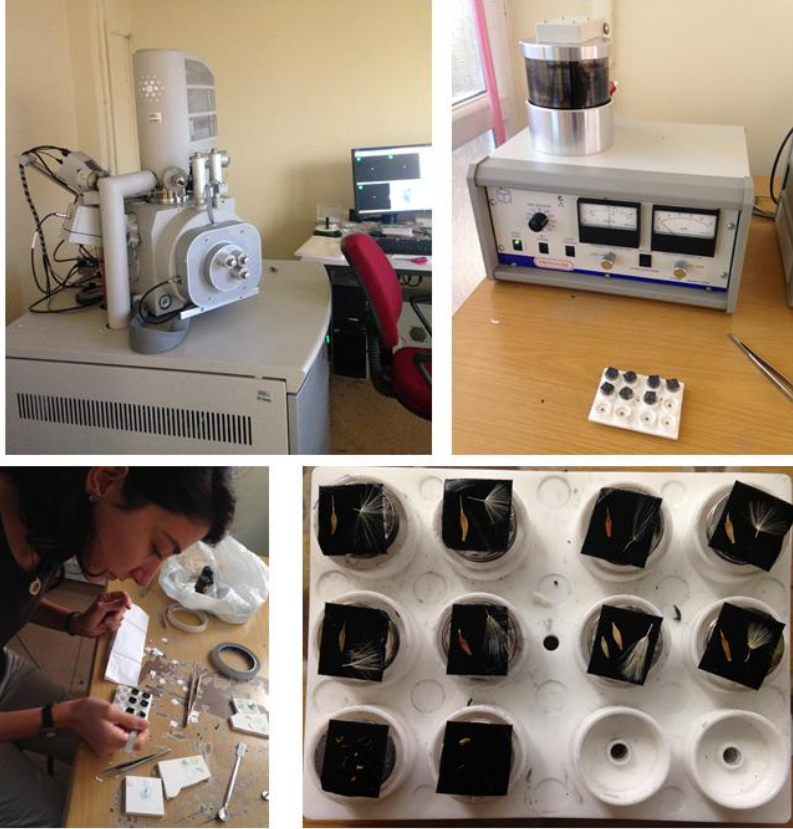
Şekil 3-4 : SEM analizi için numune hazırlanması
