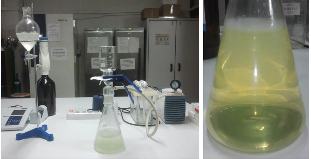
Şekil 3.15: Jelâtin Solüsyonunun Filtre Edilmesi ve Filtrasyon Sonrası Görünümü.
