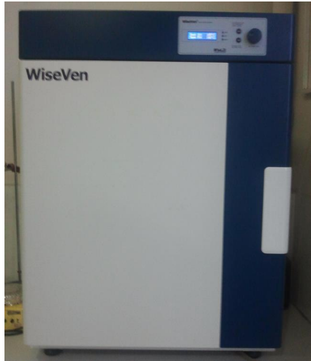
Şekil 3.23: Nem Analizinde Kullanılan Etüv.
