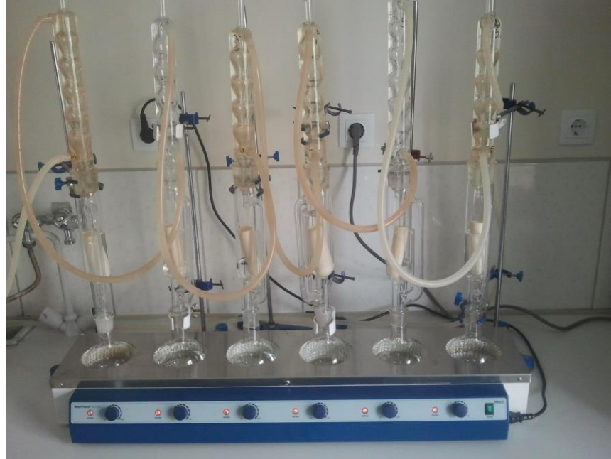
Şekil 3.22: Soxhlet Yöntemiyle Yağ Analizinin Yapılması.
