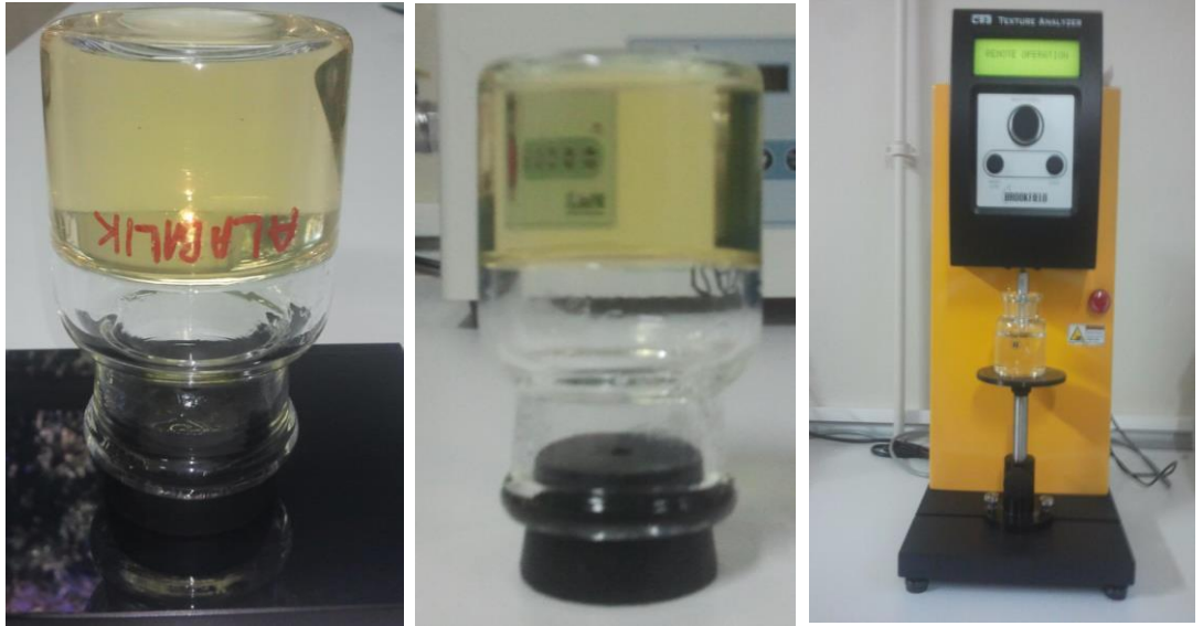
Şekil 3.26: Jelleşen Solüsyon ve Mukavemetinin Tekstür Cihazıyla Ölçülmesi.
