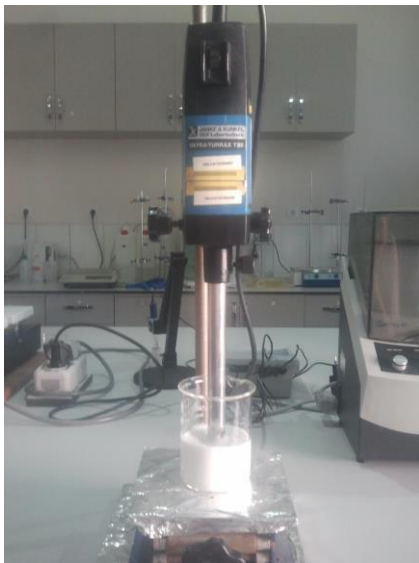
Şekil 3.25: Köpük Testlerinde Kullanılan Ultra Turrax ve Test Sonrası Görünüm.
