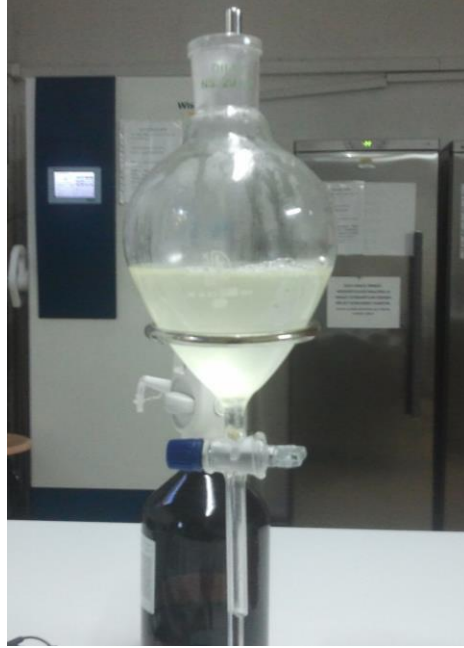
Şekil 3.14: Santrifüj İşlemi Sonrası Ayırma Hunisiyle Yağ Ayrımı.
