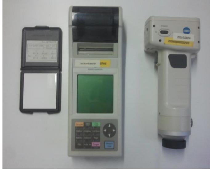
Şekil 3.31: Renk Analizinde Kullanılan Renk Ölçer Cihazı.
