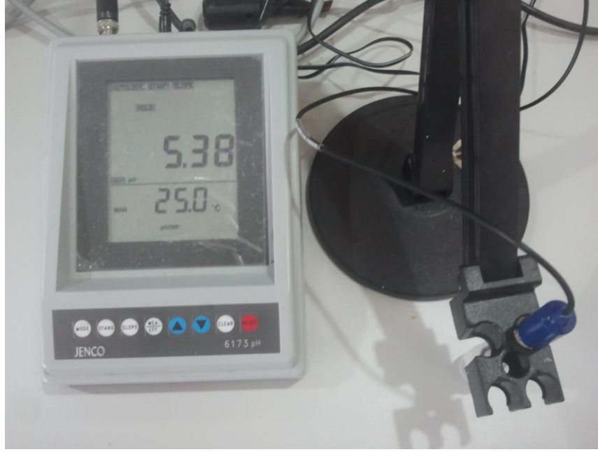
Şekil 3.27: pH Analizinde Kullanılan pH Metre.
