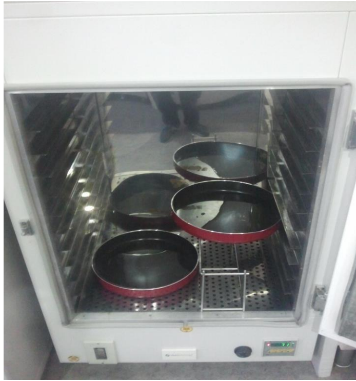
Şekil 3.18: Filtrasyon Sonrası Solüsyonların Etüvde Kurutulma Aşaması.
