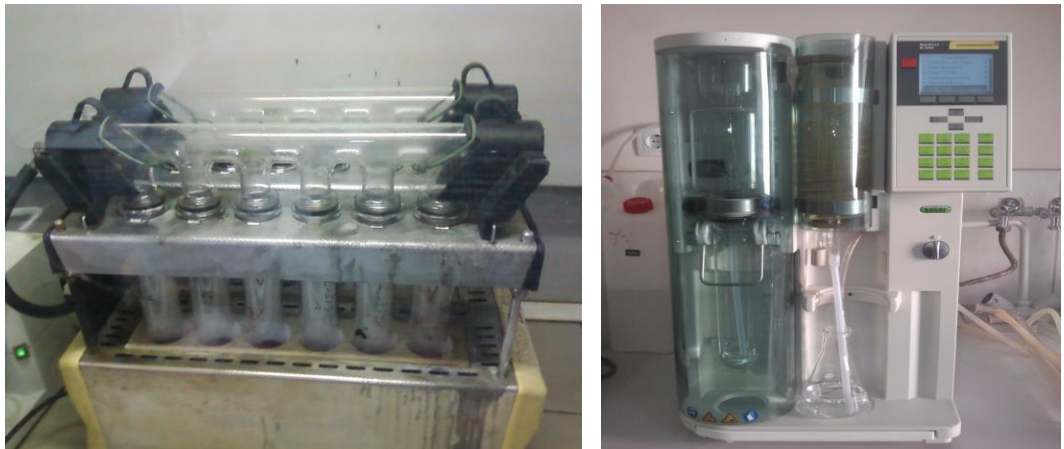
Şekil 3.21: Protein Yakma Ünitesi ve Protein Destilasyon Cihazları.
