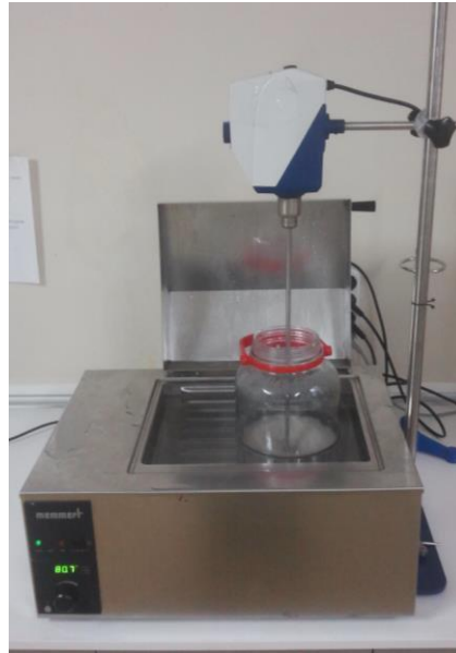
Şekil 3.10: Sıcak Su Ekstraksiyonu İşleminin Uygulanması.
