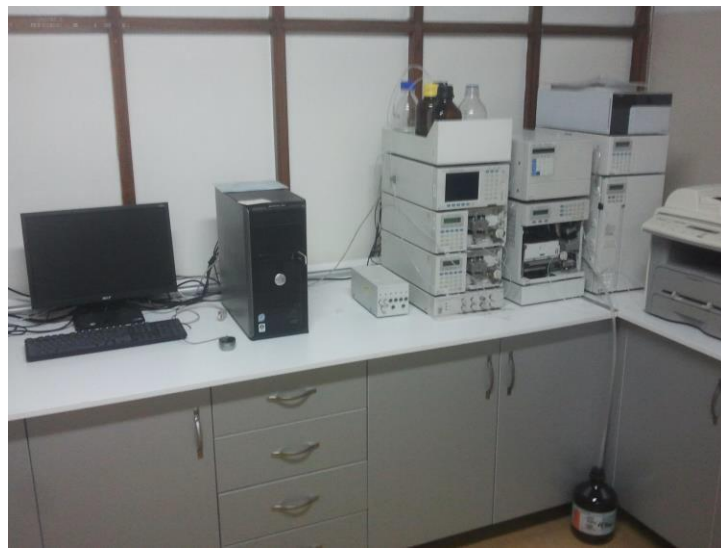
Şekil 3.29: Aminoasit Analizlerinde Kullanılan HPLC Cihazı.
