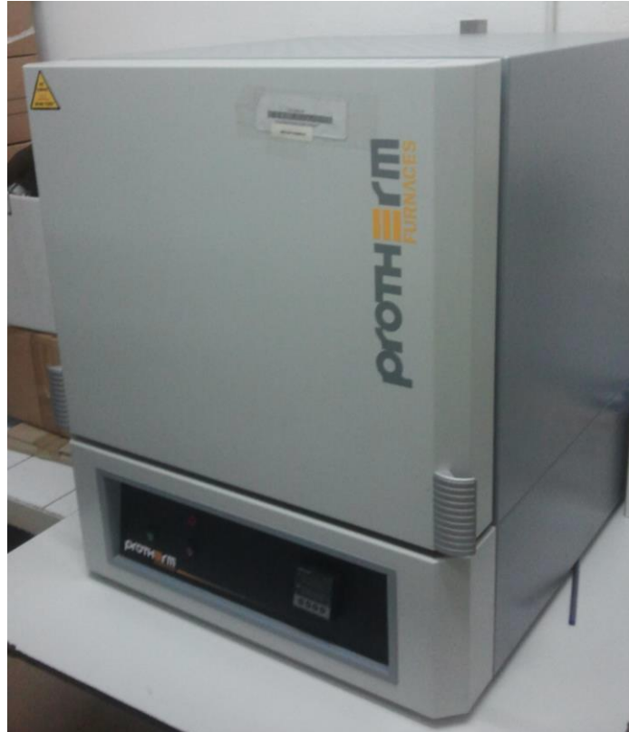
Şekil 3.24: Kül Analizinde kullanılan Kül Fırını.
