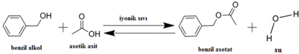
Şekil 3.14: Benzil alkol ve asetik asidin esterifikasyon reaksiyonu.
