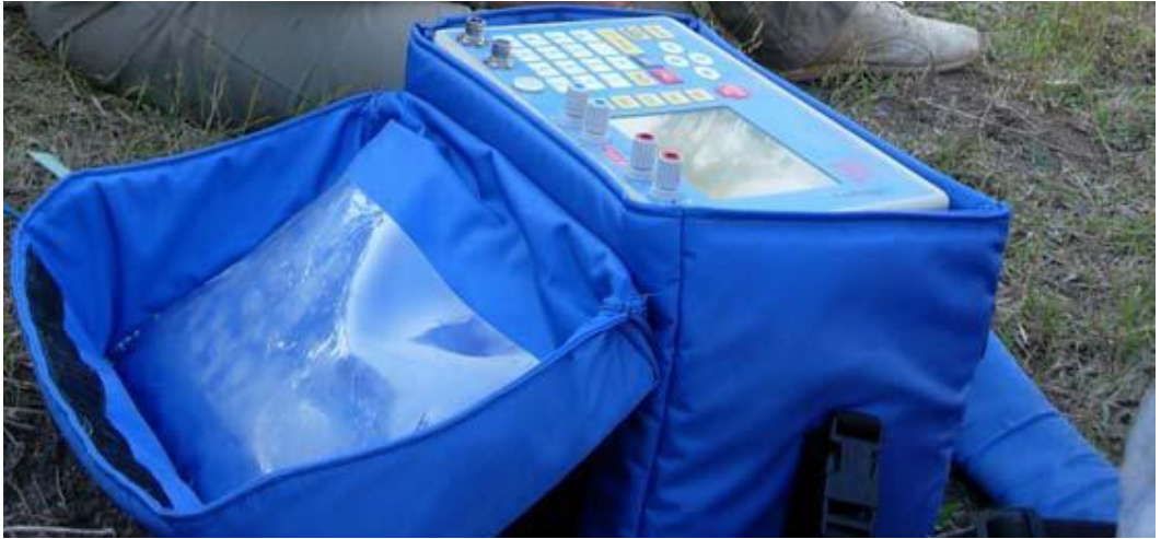
Şekil 7.37. ARIS Scintrex çok kanallı öz direnç aleti
