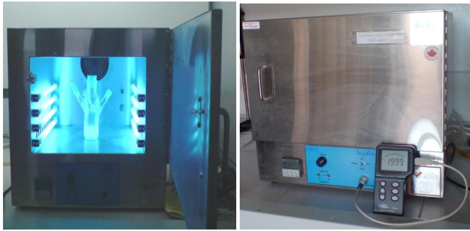
Şekil 3.2: Fotokatalitik reaksiyonlarda kullanılan fotoreaktörün reaksiyon esnasında iç ve dış görünümü.
