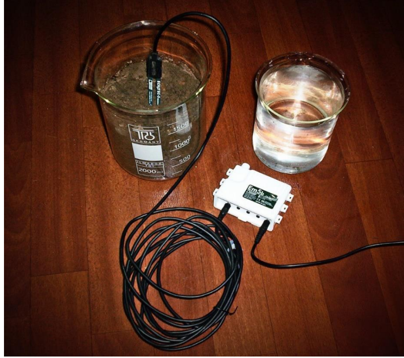
Şekil 3.5: Toprak nem sensörlerinin nemli toprak, hava ve su içinde kontrol edilmesi işlemi.
