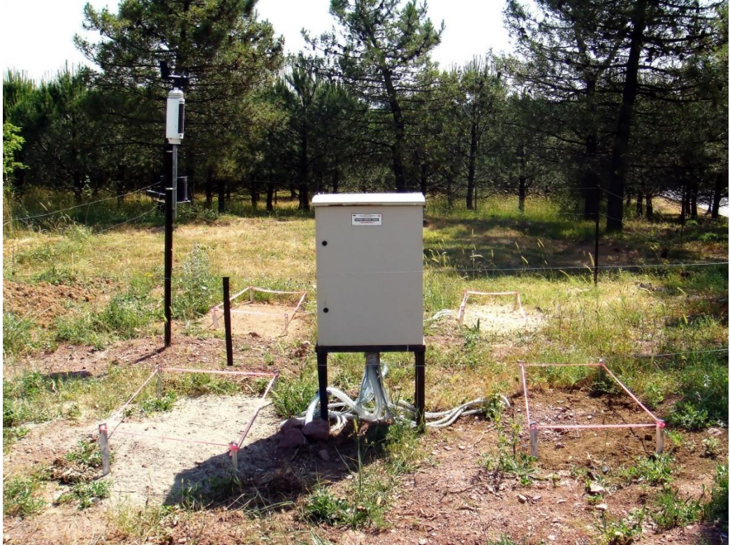
Şekil 3.16: Gebze istasyonlarının yer aldığı sahanın genel görünümü. 4 farklı zemini temsil eden çukurlar, veri kayıt ve online erişim ekipmanını içeren metal pano ve otomatik meteoroloji gözlem cihazı.
