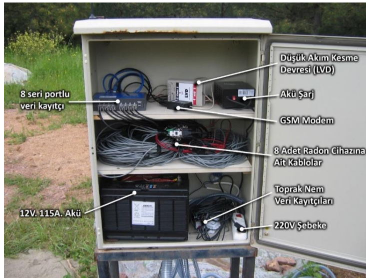
Şekil 3.15: Gebze’de yer alan 4 istasyona ait 8 adet radon cihazında ölçülen toprak radon verilerini kaydeden ve online erişime imkan veren sistem.
