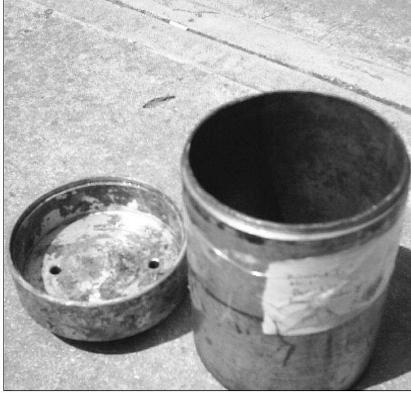
Şekil 3.2. Zemin Örneği Alma Çalışmalarında Kullanılan Silindirik Tüp ve Başlık
