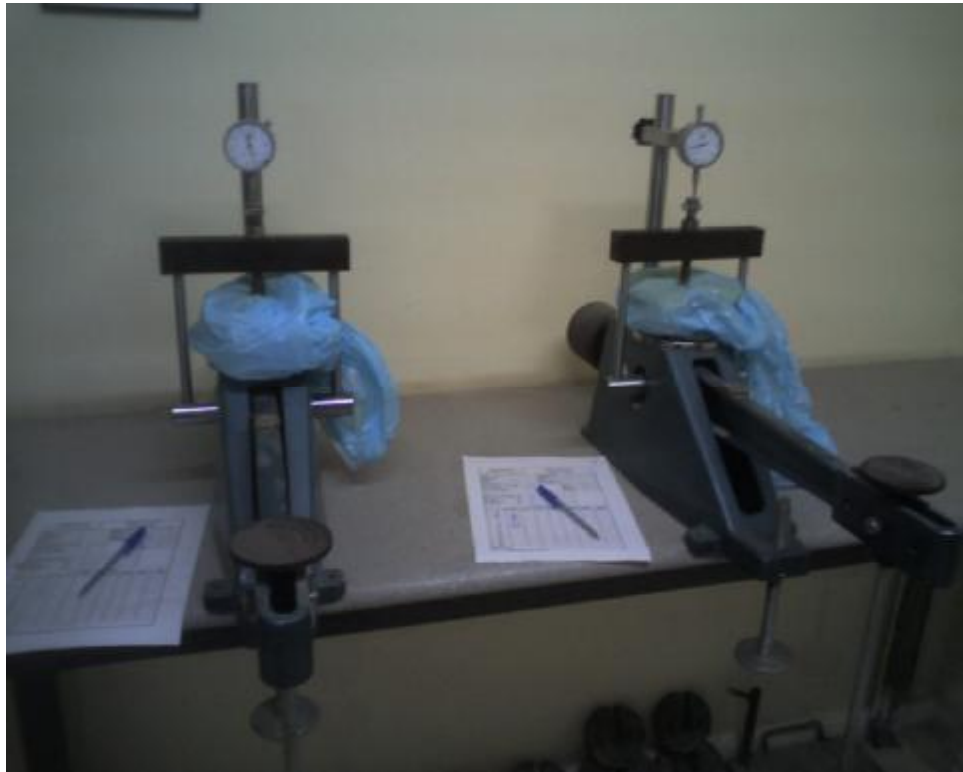
Şekil 3.4. Doymun Olmayan Zeminlerde Konsolidasyon Deney Düzenegi
