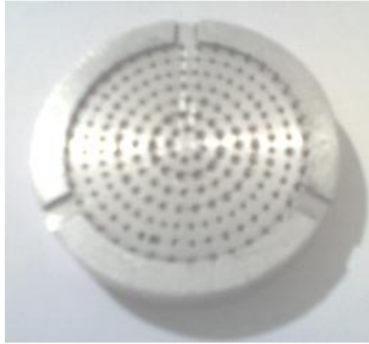
Şekil 3.5. Metal Malzemedен İmal Edilen Poroz Taş
