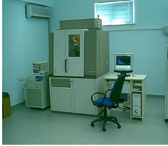
Şekil 3.1: X-ışını difraksiyonu (XRD) analizinde kullanılan cihaz
