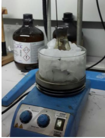
Şekil 3.1: Buz banyosunda bekleyen grafit çözeltisi ve hazırlanan parlak sarı renkli grafit oksit çözeltisi.
