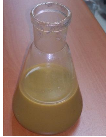
Şekil 3.1: Buz banyosunda bekleyen grafit çözeltisi ve hazırlanan parlak sarı renkli grafit oksit çözeltisi.
