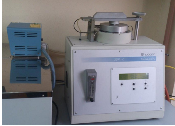
Şekil 3.8: ASTM D1434 yöntemine göre ölçüm yapan gaz geçirgenlik test sistemi.
