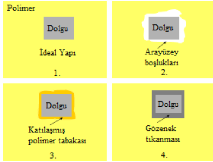
Şekil 2.16: Karmaşık yapıli matris membranlarda çeşitli nano boyutlu yapıların morfolojisi.
