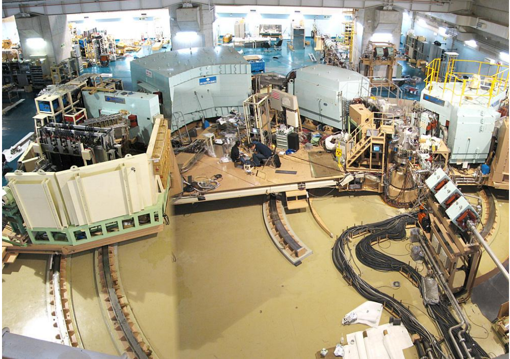
Şekil 3.7: RCNP Araştırma Merkezi 0° ölçümlerinde kullanılan manyetik spektrometreler.
