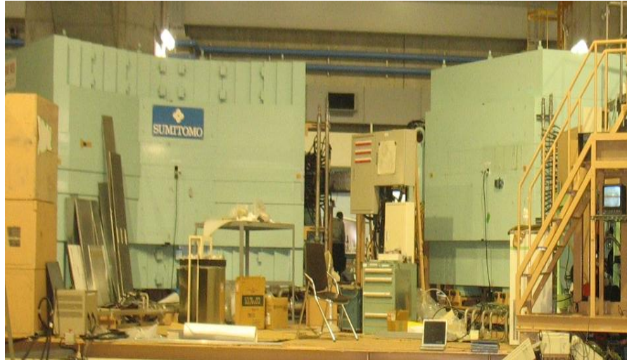
Şekil 3.14: GR spektrometresinde bulunan D1 ve D2 dipol magnetleri.
