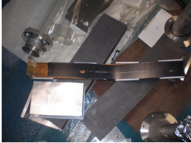
Şekil 3.9: GR spektrometresinde D1 magnetinin içinde yer alan Faraday kap.
