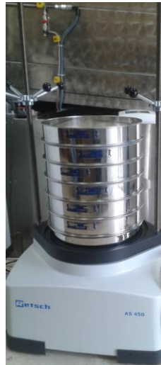
Şekil 3.35: Elek Sarsma Cihazı ve Petrokokun Elenmesi İşlemi.
