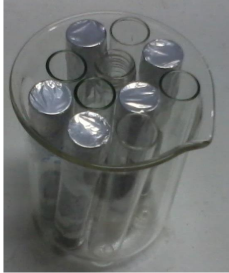
Şekil 3.31: Bitüm ve Bitüm Fraksiyonlarının Isıl İşleme Tabi Tutulması.
