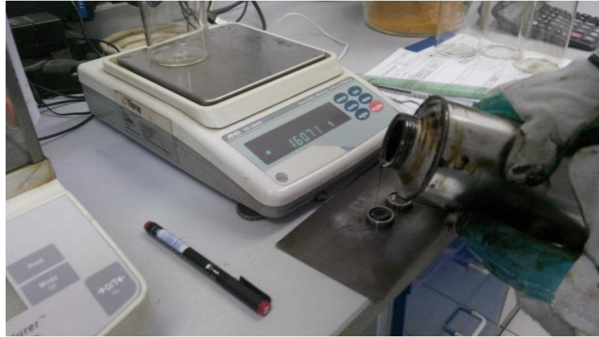
Şekil 3.4: Numunenin Disklere Dökülmesi.
