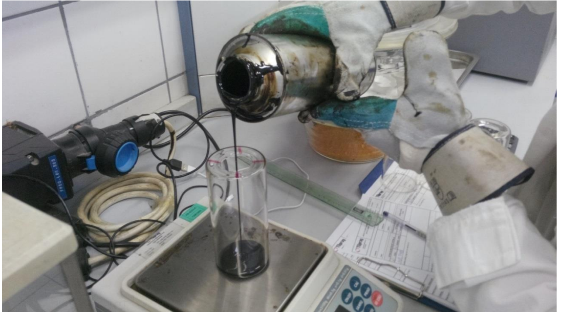
Şekil 3.8: Numunenin Tartılarak Cam Kaba Aktarılması
