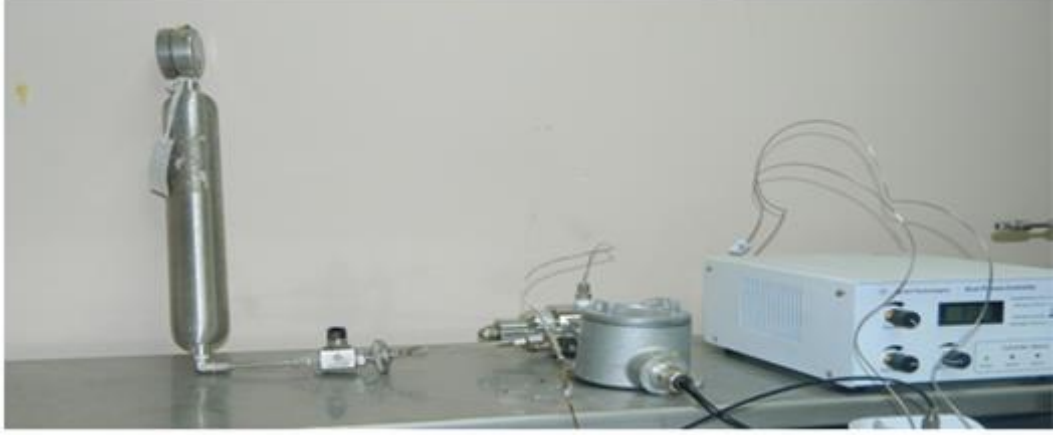
Şekil 3.41: GC-SCD Online Analiz Düzeniği.
