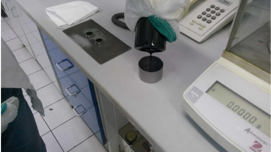
řekil 3.11: RTFOT Sonrası Penetrasyon Testi.
