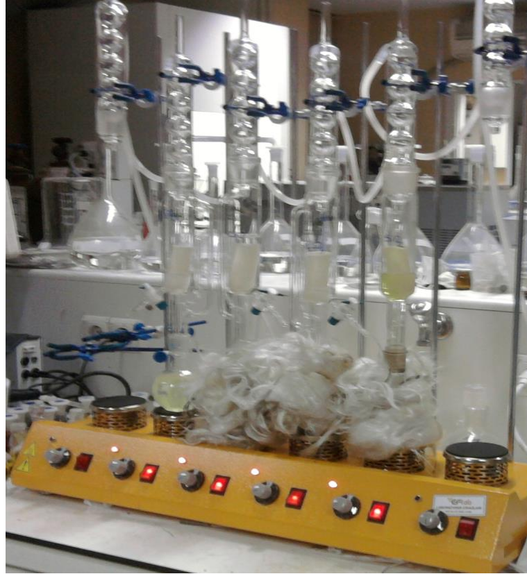
Şekil 3.33: Soxhlet Ekstraksiyonuyla Petrokok ve Bitümüm Ayrılması.
