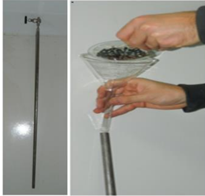
Şekil 3.40: Aktif Kok ve Seramiklerin Yükleneceği Hat Düzeneği.
