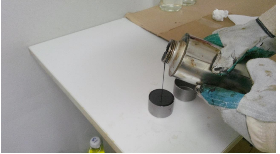
Şekil 3.1: Numunenin Penetrasyon Kabına Dökülmesi.
