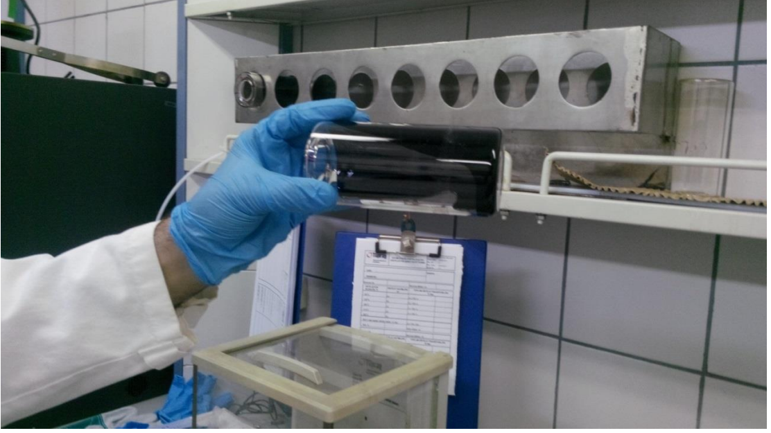
Şekil 3.9: Numunenin Desikatöre Yerleştirilmesi.
