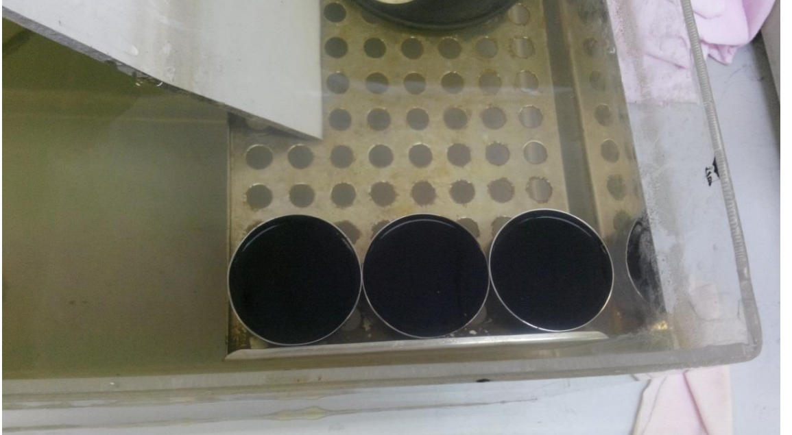
Şekil 3.2: Su Banyosuna Konulmuş Penetrasyon Kapları.
