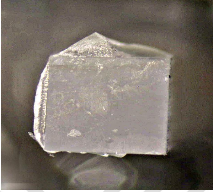
Şekil 4.1. Dentinde Görülen Koheziv Başarısızlık ( 30 sn Total-Etch )
