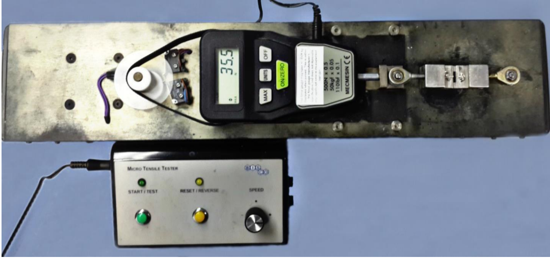
Şekil 3.23. Çekme Kuvveti Uygulanan Deney Çubuklarının Kopma Anı (BISCO inc, Schaumburg, L, USA)
