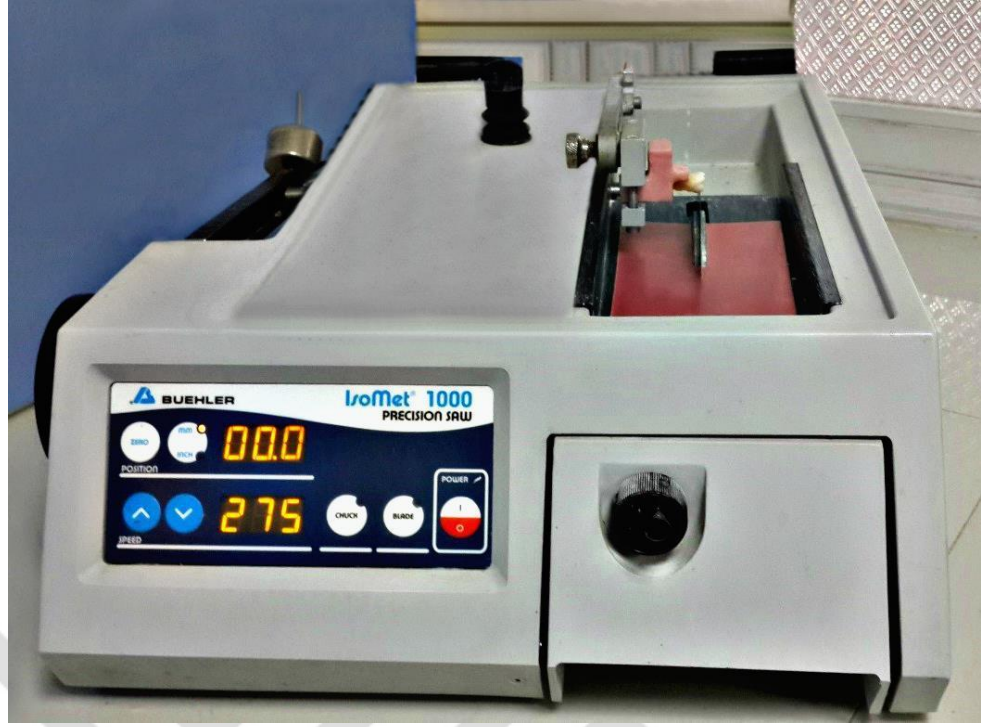
Şekil 3.6. Isomet 1000 Cihazı (Buehler Precision Saw, Düsseldorf, Germany)
