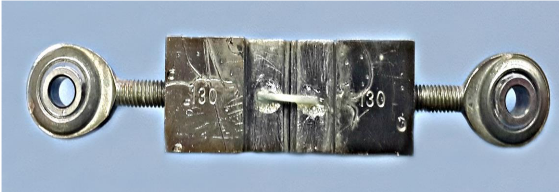
Şekil 3.22. 1mm Alanındaki Deney Çubuklarının Siyanoakrilat Adeziv Ajan ile Sabitlenmesi
