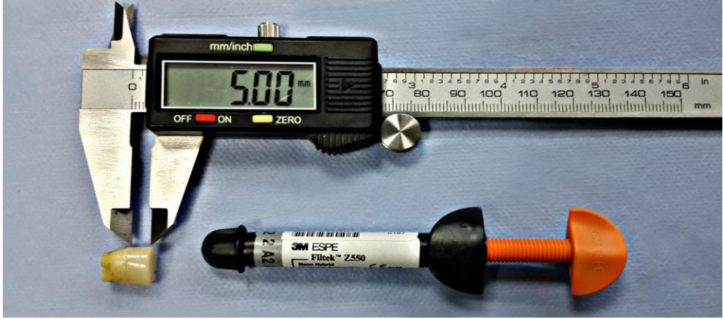
Şekil 3.14. 5 mm Yüksekliğinde Kompozit Blok Oluşturulması
