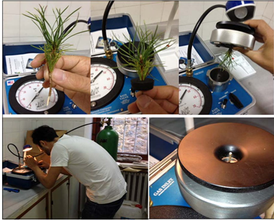
Şekil 3.14: Transpirasyon analizi sırasında fidanlarda su potansiyeli ölçümleri.
