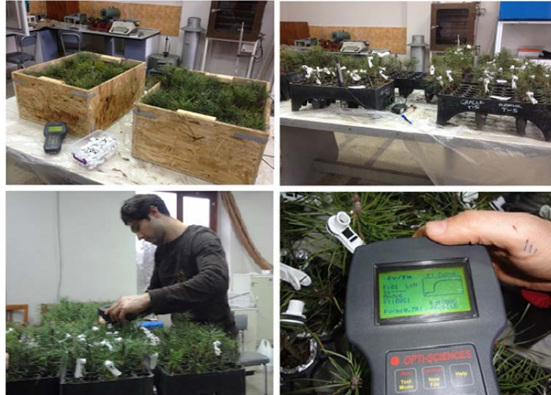
Şekil 3.25: Kışın don testlerinde klorofil florometre ölçümleri.
