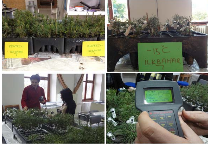
Şekil 3.26: İlkbahar don testlerinde klorofil florometre ölçümleri.
