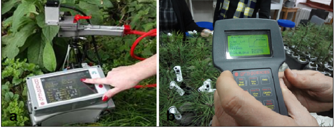
Şekil 2.22: Farklı model klorofil florometre cihazları ile a- doğa şartlarında b-laboratuvarda test sonrası klorofil floresans ölçümü
