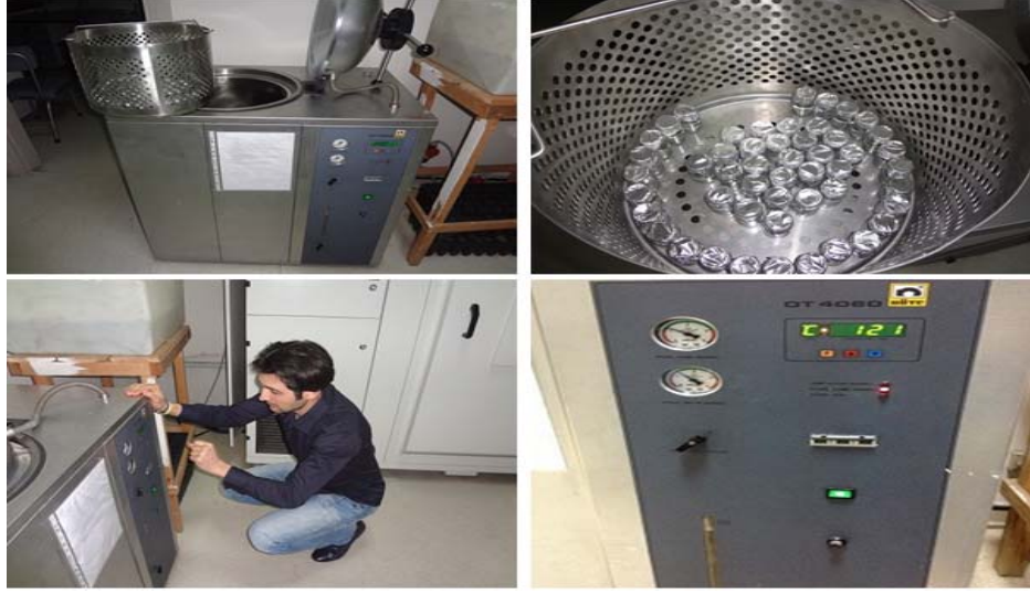
Şekil 3.23: İğne yaprak segmentlerinin otoklavlanarak tamamen öldürülmesi.
