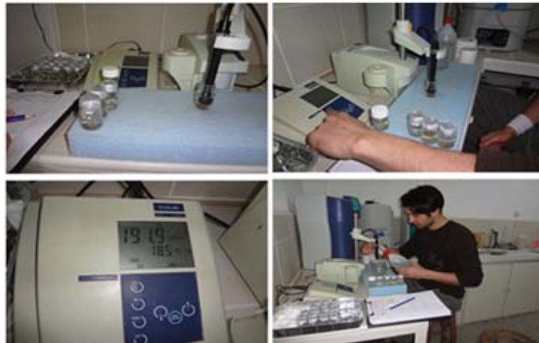
Şekil 3.22: Örnekler üzerinde ilk elektriksel iletkenlik ölçümleri.
