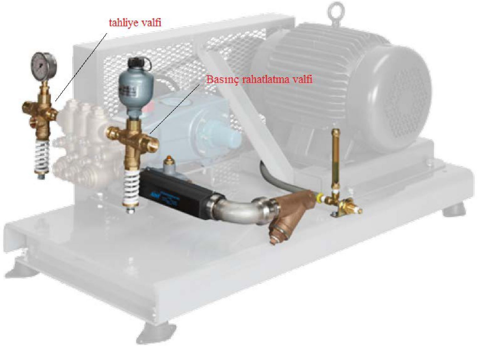
Şekil 2.7: Tahliye valfi ve Basınç rahatlatma valfi
