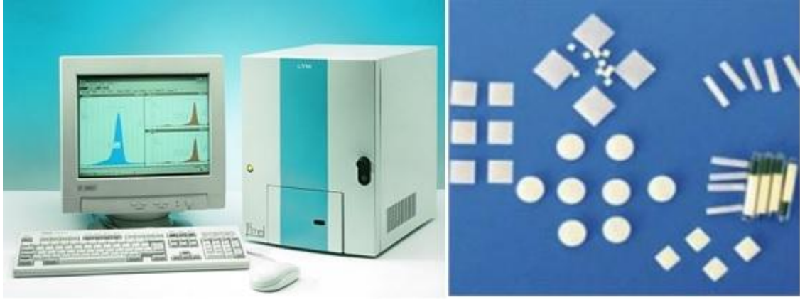
Şekil 3-8 Fimel LTM TLD okuyucu ve bilgisayar sistemi, çeşitli şekillerdeki TL dozimetreler
