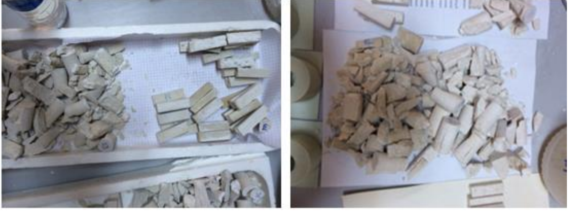
Şekil 4.45: Üç nokta kırma ve basma testleri sonucu revetman numuneler.
