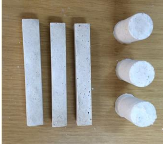
Şekil 3.9: Çubuk ve silindir kalıplardan çıkarılan revetmanlar.
