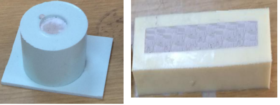
Şekil 3.7: Revetmanın farklı kalıplara alınması.
