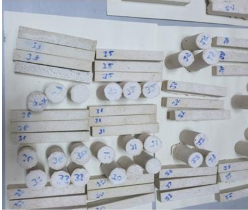
Şekil 3.8: Çubuk ve silindir kalıplardan çıkarılan revetmanlar.
