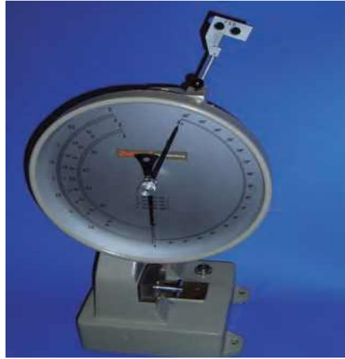
Şekil 2.26: Darbe mukavemetinin ölçülmesinde kullanılan Charpey Impact test aleti.
