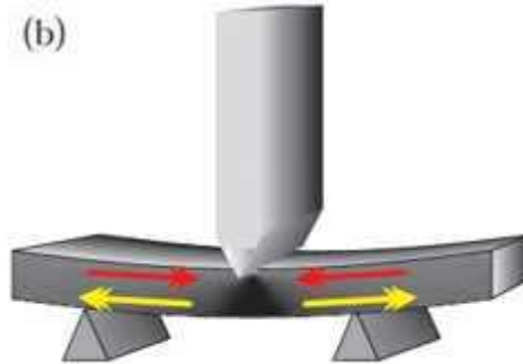
Şekil 2.18: Kirişin bükülmesi germe ve baskı gerilimlerini aynı anda oluşturur.
