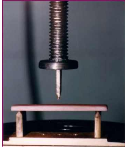
Şekil 2.19: Üç nokta veya transvers testinin uygulanması.
