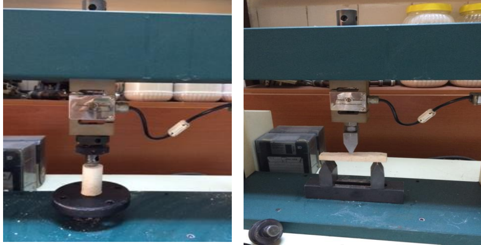
Şekil 3.10: Basma ve üç nokta kırma testleri için kullanılan düzenekler.
