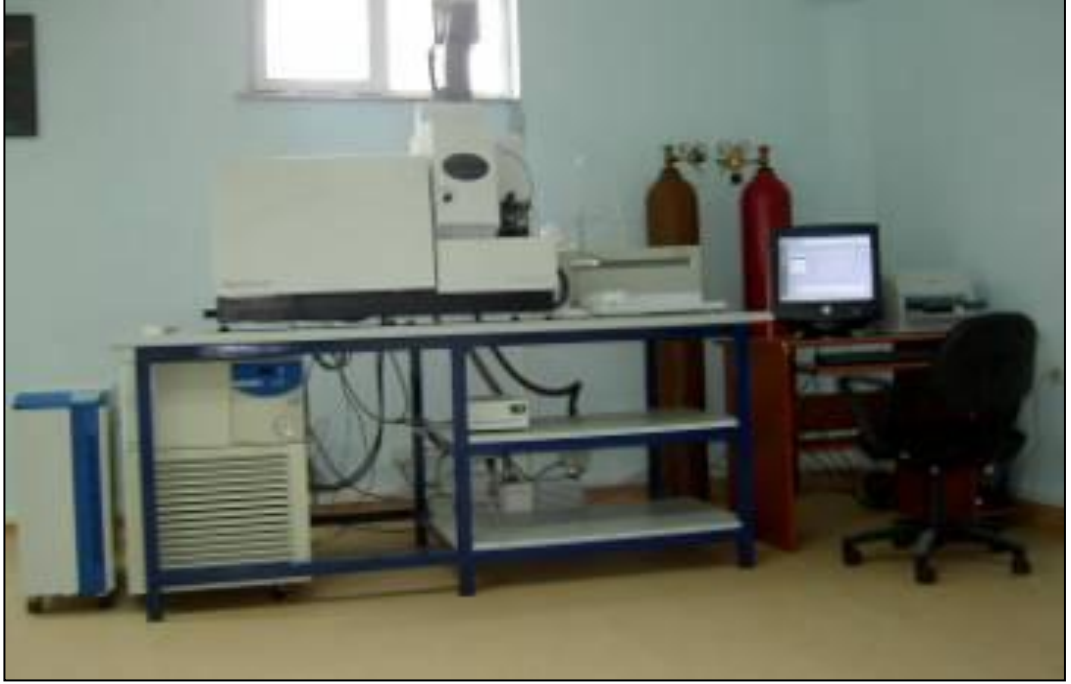
Şekil 3. 9: İndüktif eşleşmiş plazma kütle spektrometresi (TTM MERLAB, 2015)
