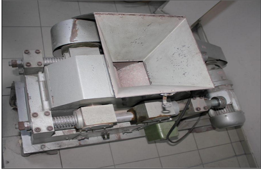
Şekil 3. 3: Deneylerde kullanılan laboratuvar tipi merdaneli kırıcı
