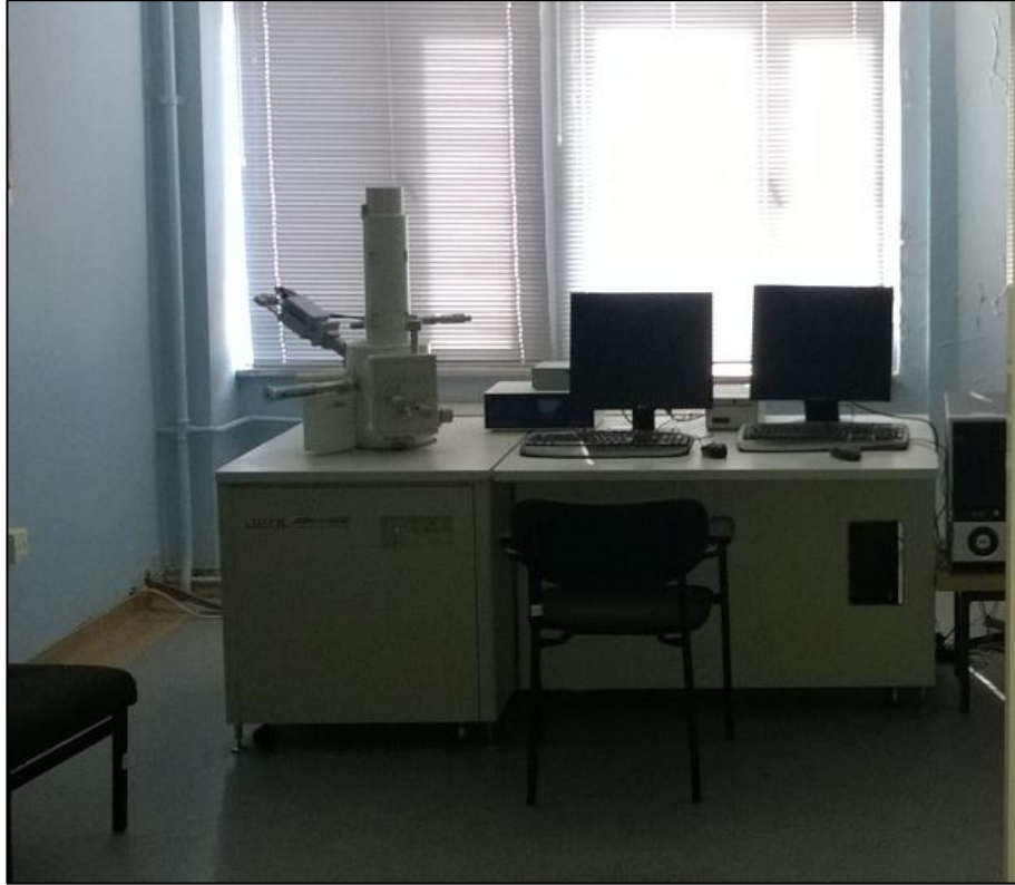
Şekil 3. 11: Quanta FEG 450 taramalı elektron mikroskobu (SEM) cihazı (İÜMM, 2013)
