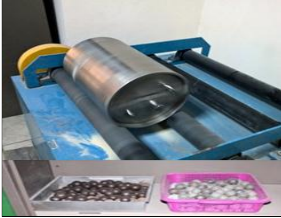
Şekil 3. 5: Bilyalı değirmen ve öğütücü ortam
