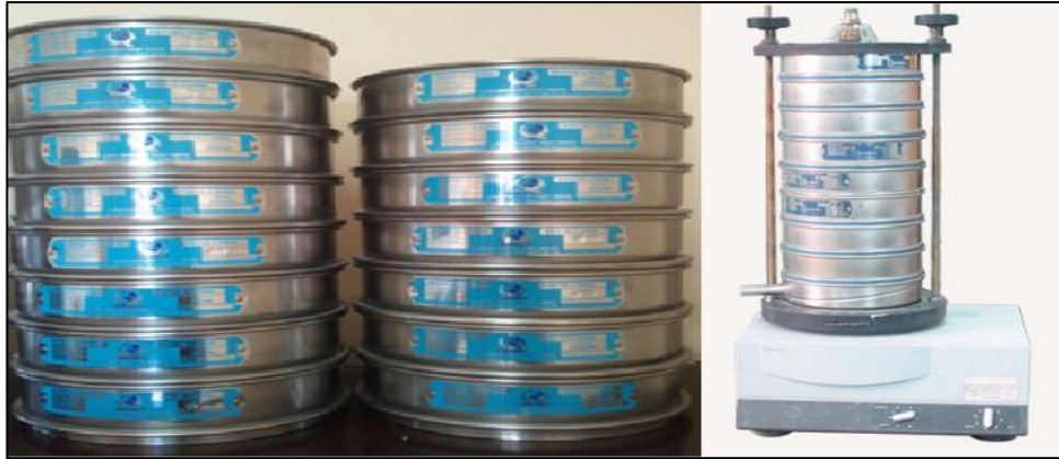
Şekil 3. 8: Tane boyutu analizlerinde kullanılan Retsch elekler
