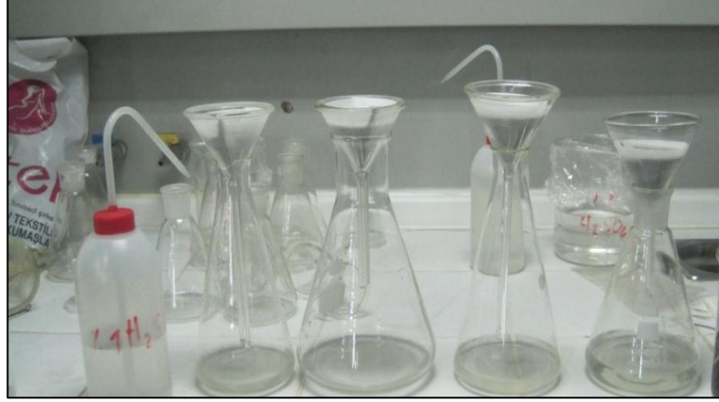
Şekil 3. 16: Liç sonrası katı-sıvı ayırımı işlemi
