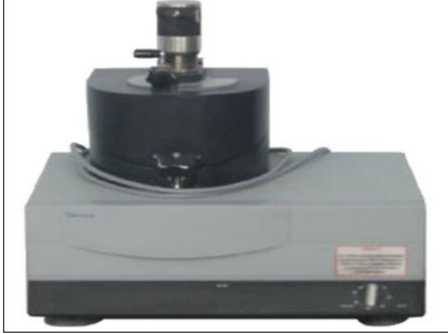
Şekil 3. 4: Numune öğütmede kullanılan Retsch agat öğütücü
