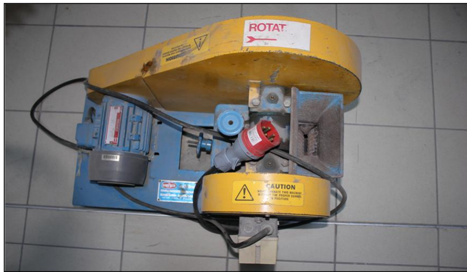
Şekil 3. 2: Deneylerde kullanılan laboratuvar tipi Denver çeneli kırıcı
