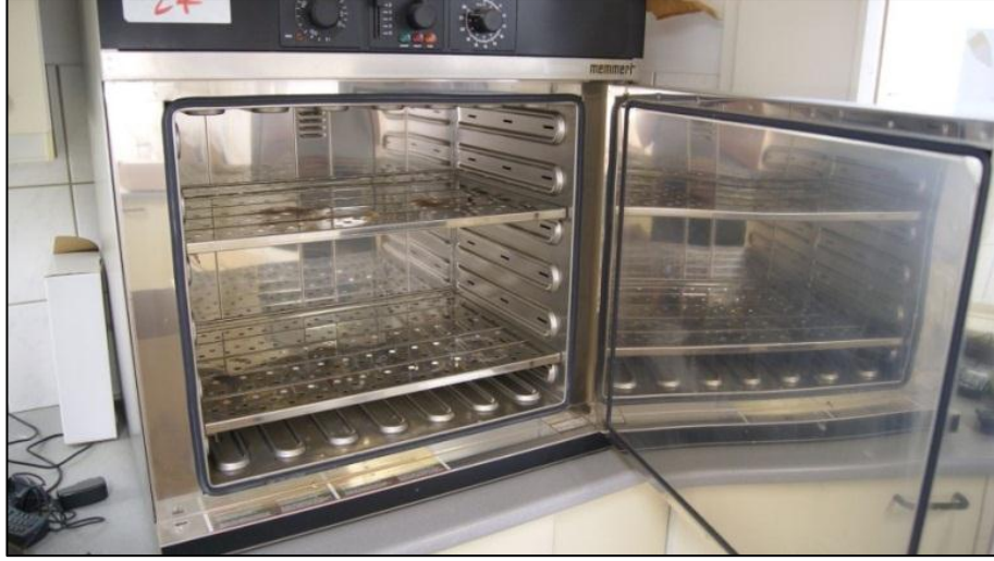
Şekil 3. 7: Nem analizlerinde kullanılan Memmert ULM500 etüv
