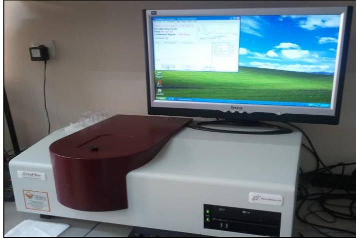
Şekil 3. 14: Brookhaven Zeta Plus zetametre
