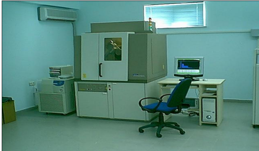
Şekil 3. 10: Rigaku D/Max-2200/PC XRD cihazı (TTM MERLAB, 2015)
