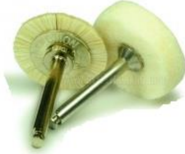
Şekil 2-9: Aşındırıcı emdirilmiş fırça ve keçe örnekleri
