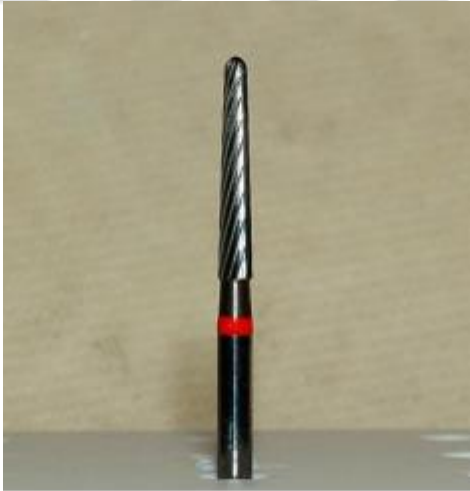
Şekil 3-11: Yüzey bitim işlemi sırasında kullanılan 12 bıçaklı tungsten karbid frez
