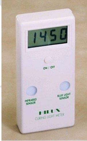
Şekil 3-13: Çalışmada kullanılan Radyometre (Hilux Led Max Curing Light Meter Optimax, Benlioğlu Dental, Ankara, Türkiye)
