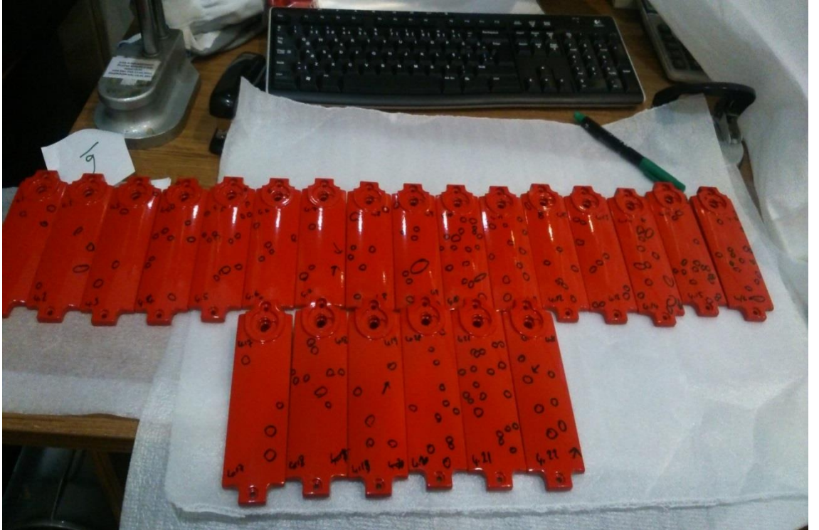
Şekil 4.8: 4 numaralı parametrede çıkan siyah noktaların dağılımı.
