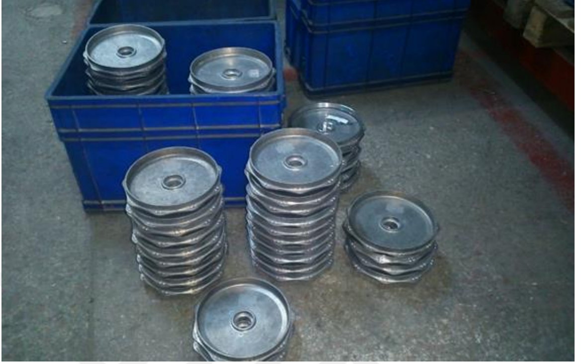
Şekil 4.1: Bifilm indeksi yüksek hammadde dökümü sonrasında ortaya çıkan hurda parçaların bir kısmı.
