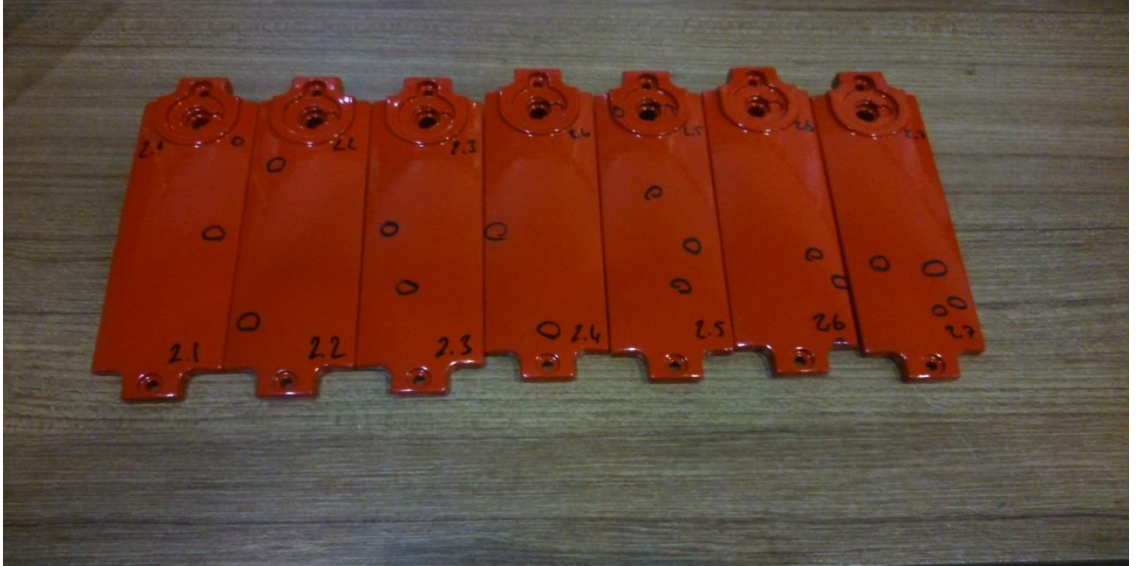
Şekil 4.6: 2 numaralı parametrede çıkan hurdaların siyah nokta dağılımı.
