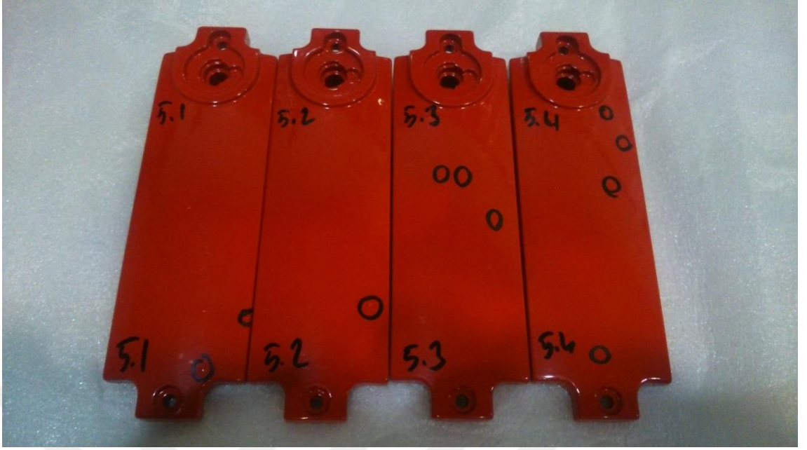
Şekil 4.9: 5 numaralı parametrede çıkan siyah noktaların dağılımı.
