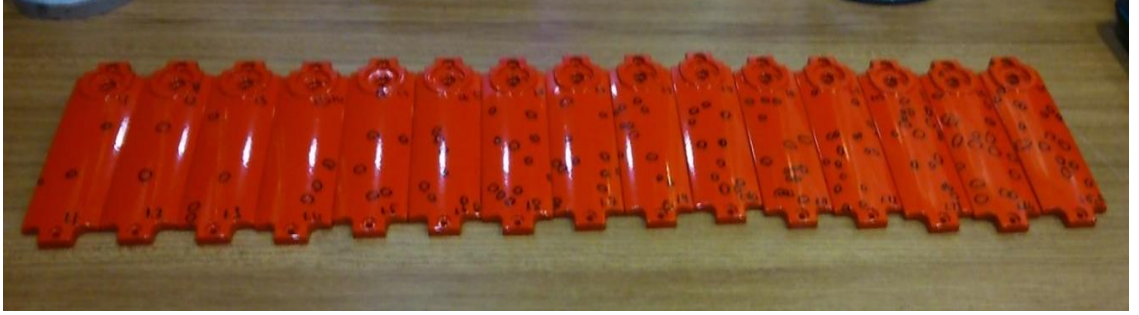
Şekil 4.5: 1 numaralı parametrede parçalarda çıkan hurdaların siyah noktaların dağılımı.
