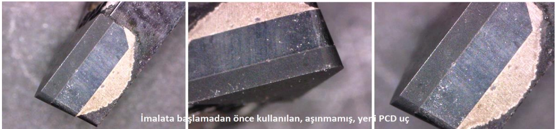
Şekil 4.22: 1. PCD ucun imalata başlamadan önceki, hiç kullanılmamış hali.
