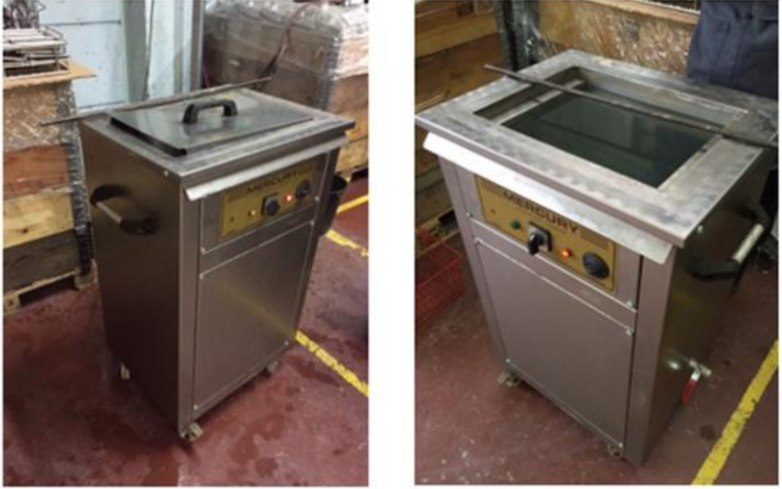
Şekil 3.3: Deneyde kullanılan prototip ultrasonik cihazı. (38 Hertz, 90 Watt)
