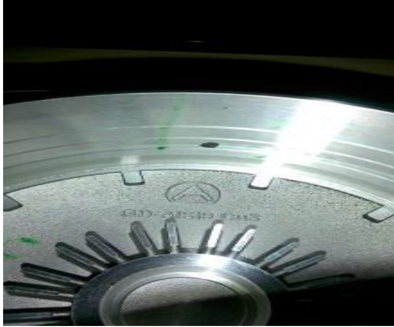
Şekil 4.32: 3. PCD ucu 92 adetteyken kırılan intermetalik.
