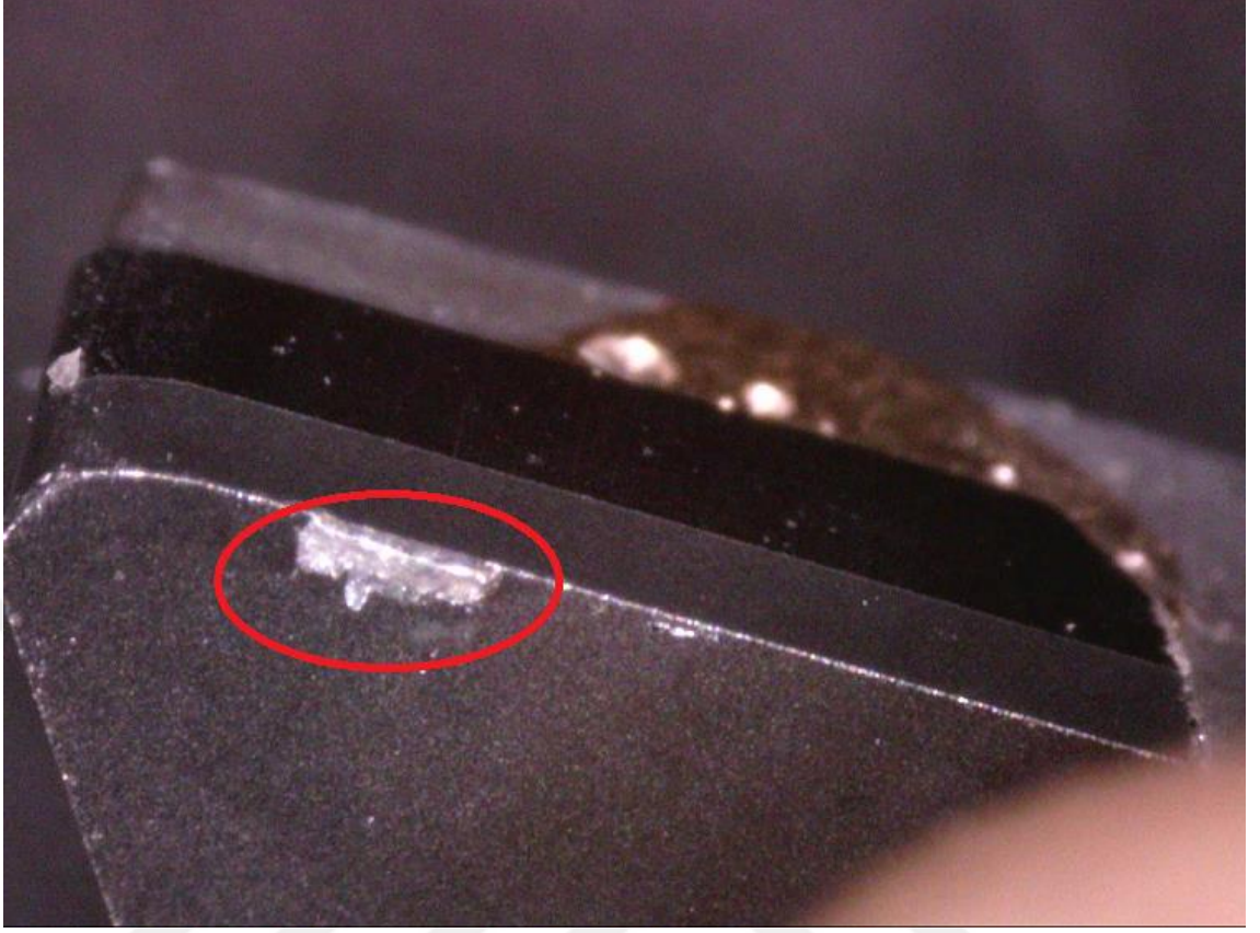
Şekil 4.31: Sadece 92 adet işleme sonrasında intermetalliğe denk gelen 3. PCD ucun kırılan alanının görüntüsü.
