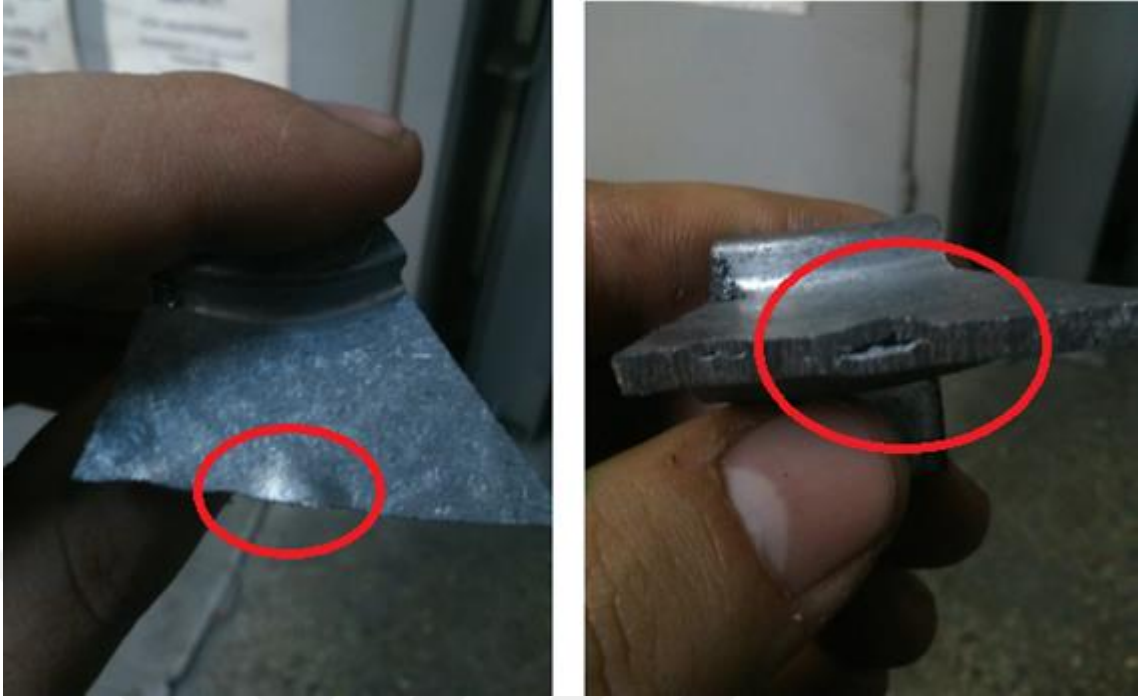
Şekil 4.3: Blisterlerin kesit görünümü.
