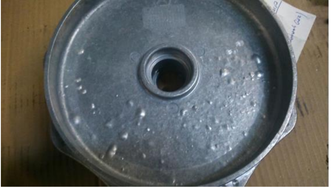
Şekil 4.2: Bilisterlerin parça üzerindeki görünümü.
