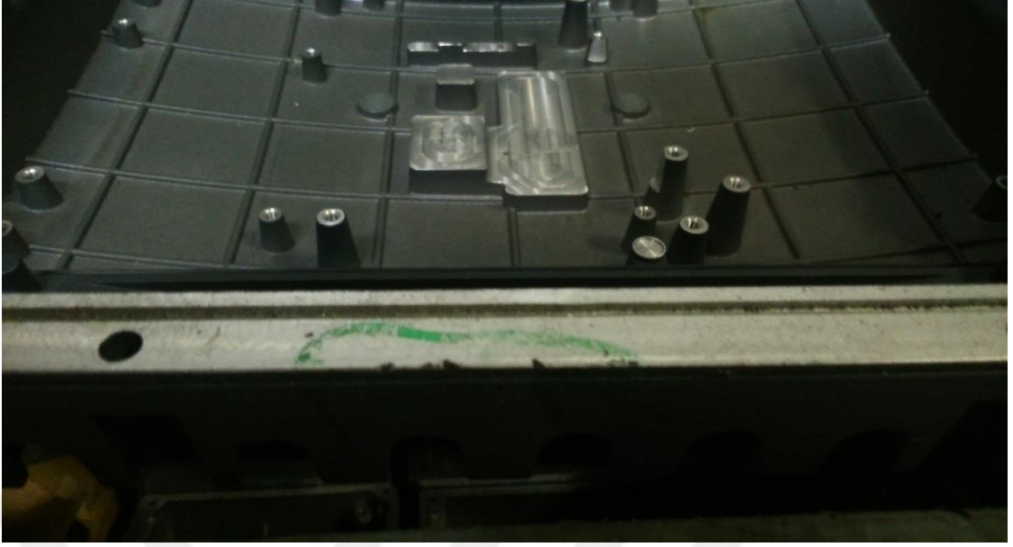
Şekil 4.38: Hava cebine ya da yolluğa denk gelmeyen intermetalikler.
