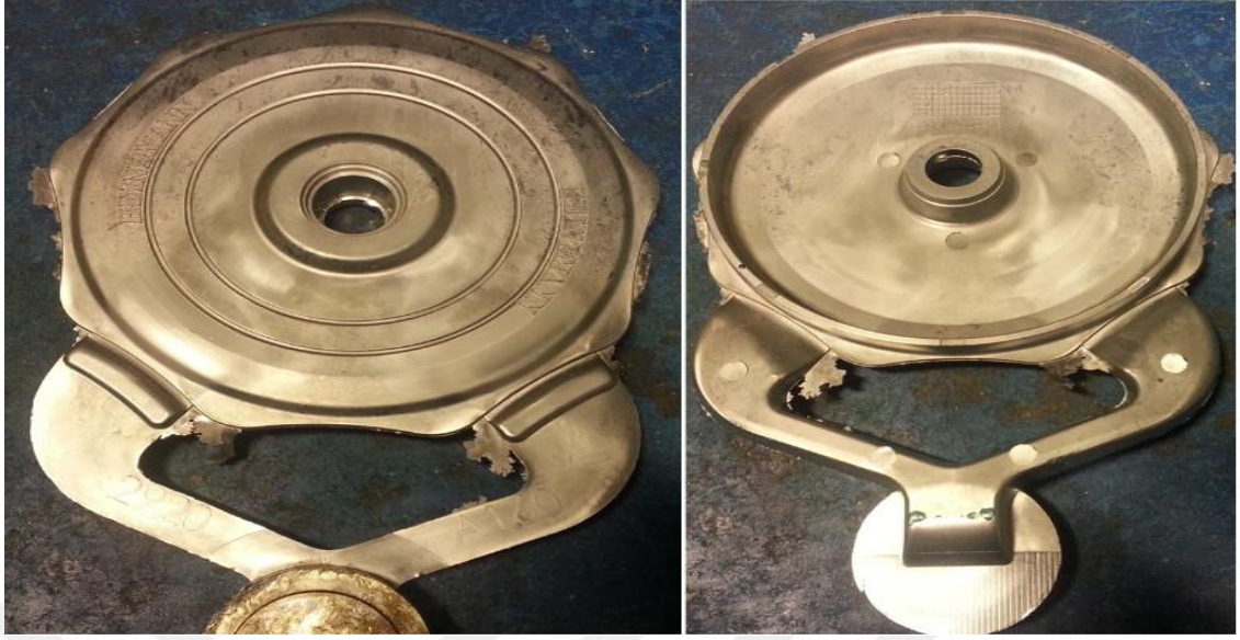
Şekil 3.2: Blister oluşumu için incelenen parçaların geometrisi.
