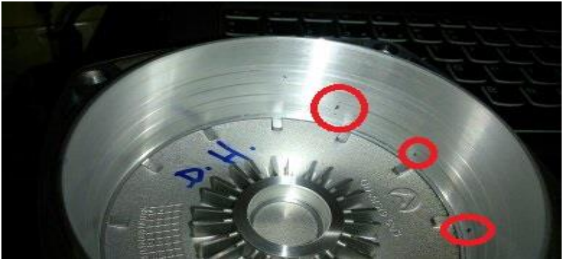
Şekil 4.30: 2. PCD ucu kıran intermetalikler.
