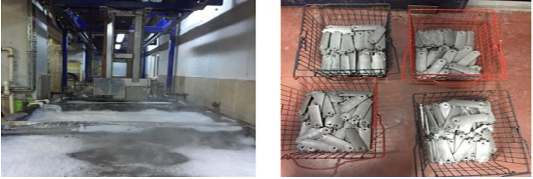
Şekil 3.7: Yüzey temizleme hattı ve parçaların sepetlere dizilişi.
