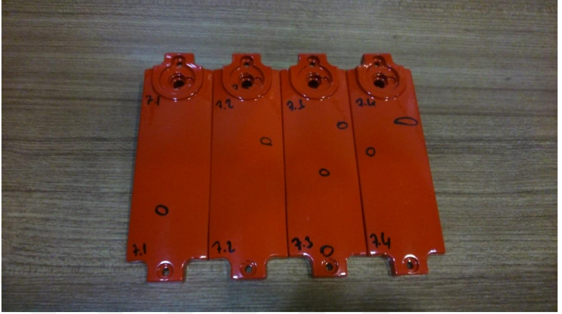
Şekil 4.11: 7 numaralı parametrede çıkan hurdaların siyah nokta dağılımı.
