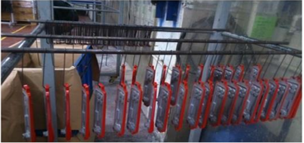
Şekil 3.9: Parçaların boya fırınına gönderilmesi.
