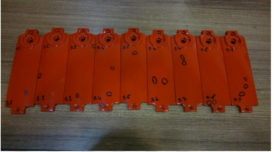
Şekil 4.7: 3 numaralı parametrede çıkan hurdaların siyah nokta dağılımı.
