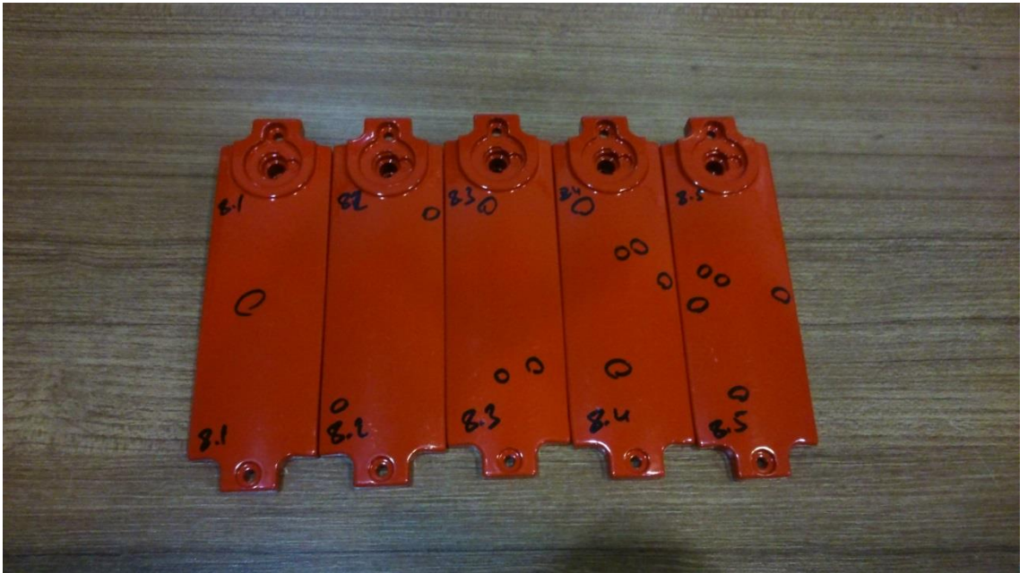
Şekil 4.12: 8 numaralı parametrede çıkan hurdaların siyah nokta dağılımları.
