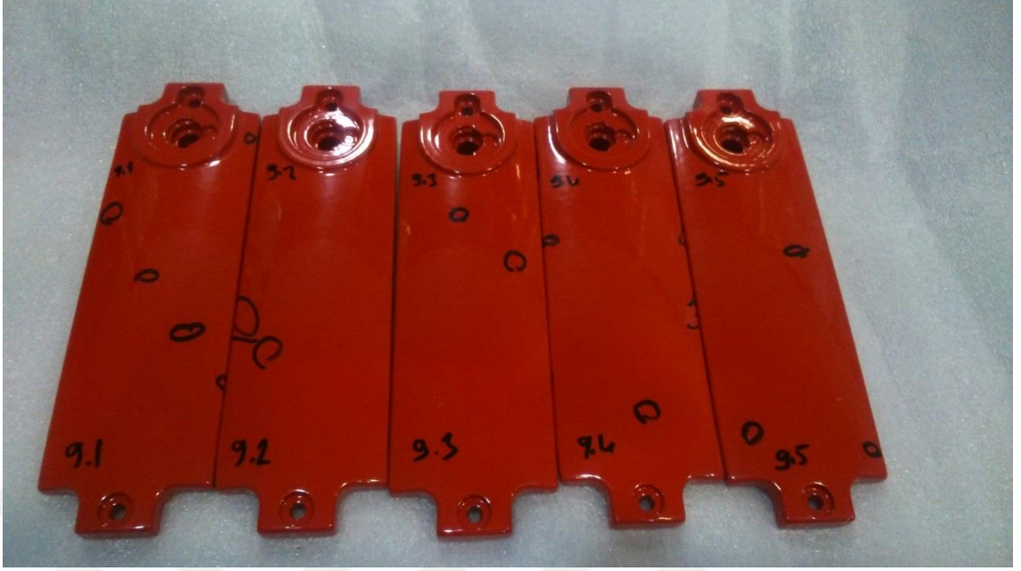
Şekil 4.13: 9 numaralı parametrede çıkan hurdaların siyah nokta dağılımları.
