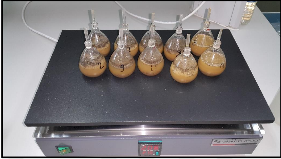
Şekil 3.14: Piknometre yardımıyla tane yoğunluğu için örneklerin ısıtılması (Foto: M.AYTEKİN, 2016).
