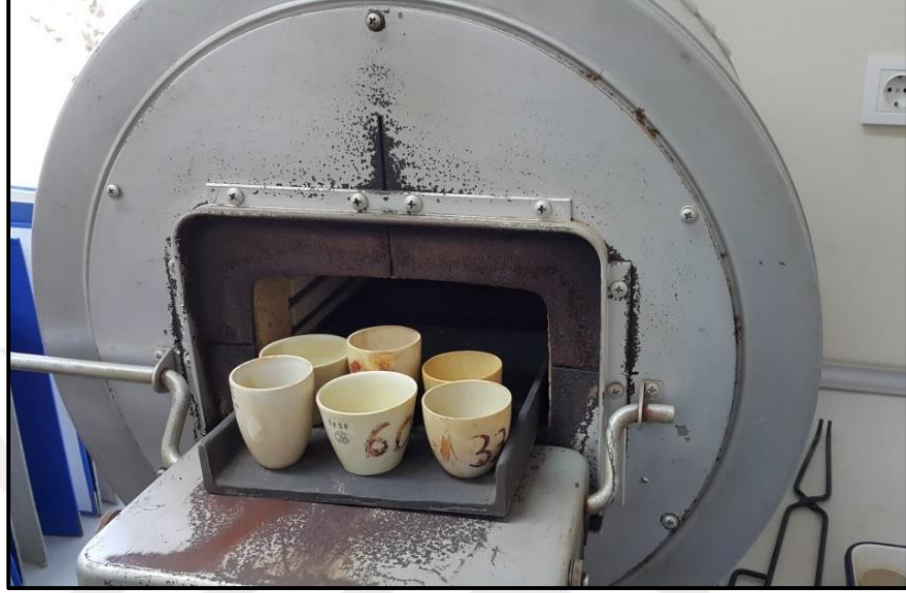
Şekil 3.17: Ateşte kayıp oranı için örneklerin yakma fırınında kurutulması (Foto: M.AYTEKİN, 2015).
