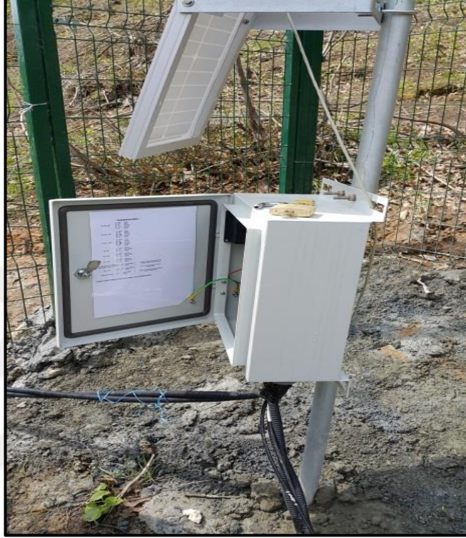
Şekil 3.8: Toprak nemi ve sıcaklık ölçer cihazı (Foto: M.AYTEKİN, 2014).
