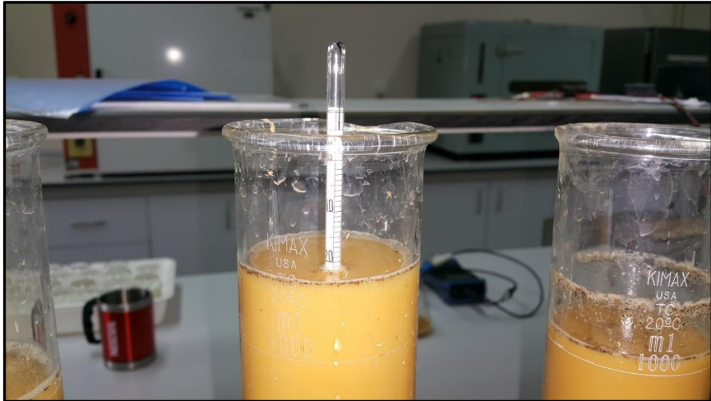
Şekil 3.13: Tekstür analizi için okumaların yapılması (Foto: M.AYTEKİN, 2015).
