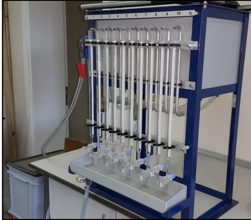
Şekil 3.10: Hidrolik geçirgenlik ölçüm cihazı (Foto: M.AYTEKİN, 2015).
