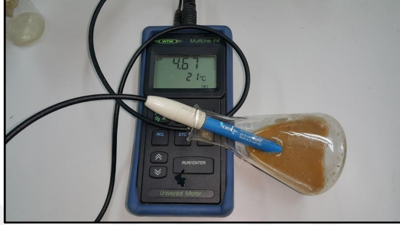
Şekil 3.19: pH okumalarının yapılması (Foto: M.AYTEKİN, 2015).
