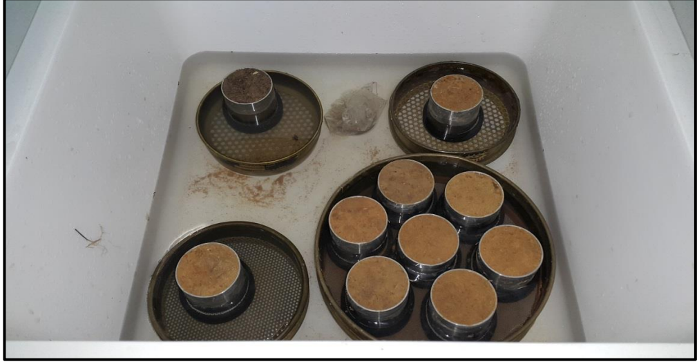
Şekil 3.9: Toprak örneklerinin doymun hale getirilmesi (Foto: M.AYTEKİN, 2015).
