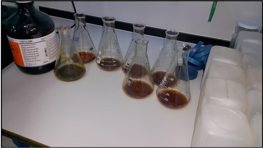
Şekil 3.15: Walkley – Black Yöntemi ile organik madde tayini (Foto: M.AYTEKİN, 2015).
