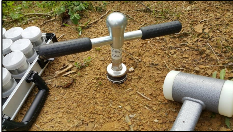
Şekil 3.7: Toprak silindir örneklerinin alınması (Foto: M.AYTEKİN, 2015).
