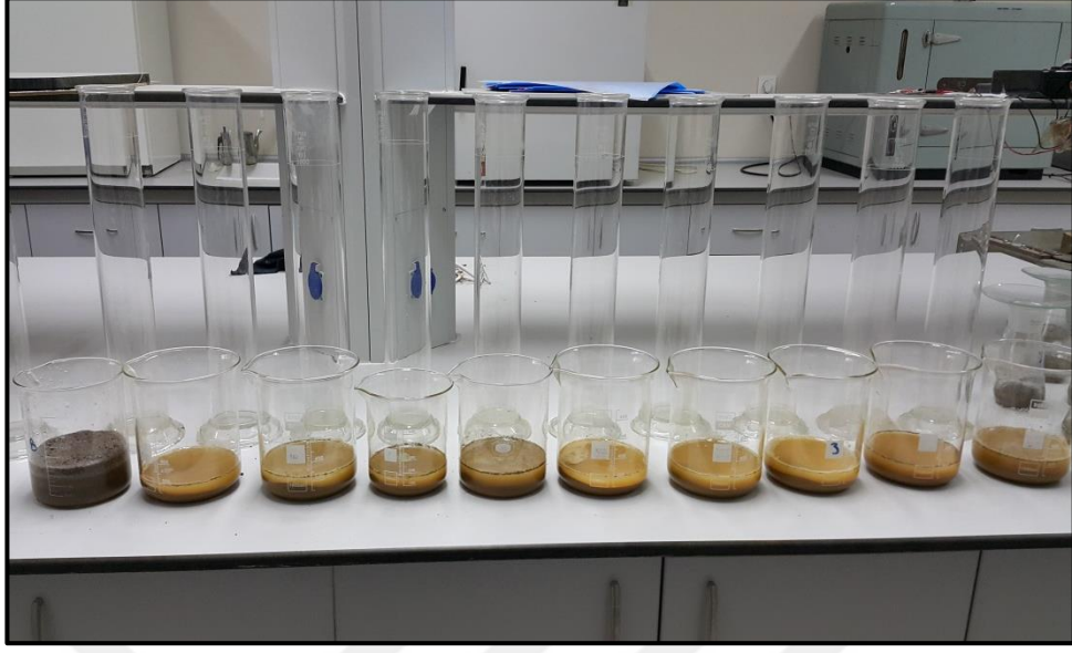
Şekil 3.12: Tekstür analizi için hazırlanmış örnekler (Foto: M.AYTEKİN, 2015).
