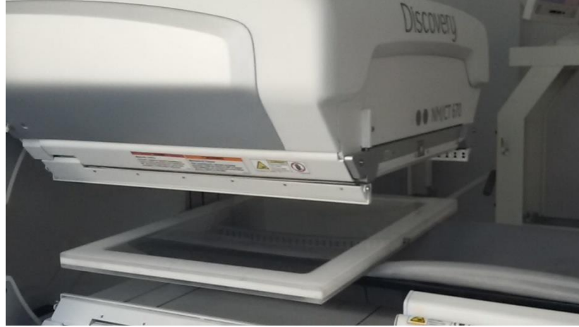
Şekil 3.4: Ekstresek homojenite test düzeneği gösterimi.
