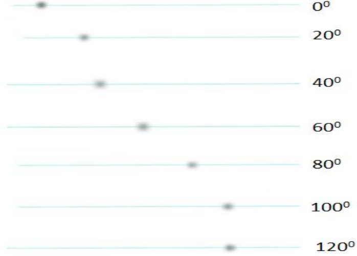
Şekil 4.18: SPECT cihazının değişen dönüş açısına bağlı olarak alınan nokta kaynak görüntüleri.
