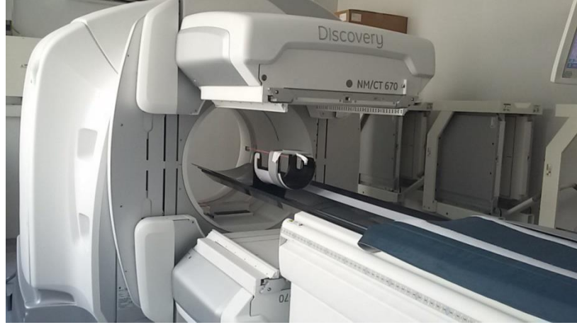
Şekil 3.8: Dedektör kafası eğim açısı testi için nokta kaynağın dedektörler arasında konumlandırılması.
