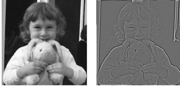
Şekil 2.4: LGN alıcı alanları çıktısı (sol: girdi resmi (gri ölçeklemeli), sağ: nöral çıktı) (Heeger, 2006).
