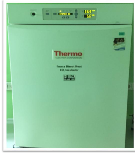
Şekil 24: % 5 CO 2 ve %95 atmosferik hava içeren, 37°C buhara doymuş CO 2 İnkübatörü (İnkübatör Thermo Forma Direct Heat, USA)
