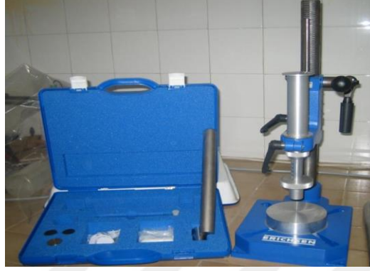
Şekil 3.3: Erichsen marka 415/E kuruma derecesi test sistemi.
