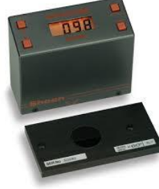
Şekil 3.5: Sheen Mini Glossmeter test cihazı.
