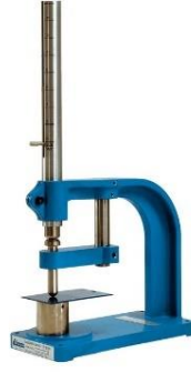
Şekil 3.8: BYK Gardner Impact Tester darbe dayanımı test sistemi.
