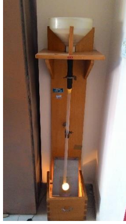
Şekil 3.7: Erichsen marka 2511-11 tipi aşınma test sistemi.
