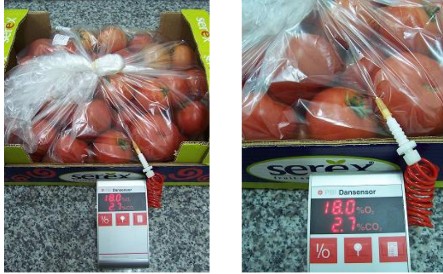
Şekil 3.8. Modifiye atmosfer paketler içerisindeki O 2 ve CO 2 miktarlarının ölçümü.
