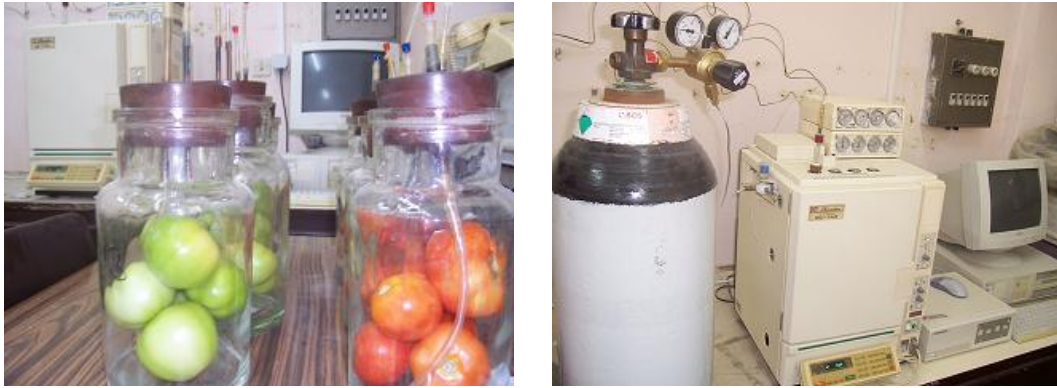
Şekil 3.9. Etilen ölçümünün yapıldığı kavanozlar ve gaz kromatografi aleti.
