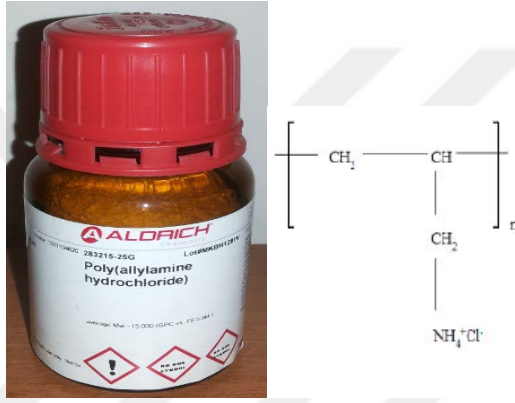
Şekil 3.1:Denemelerde kullanılan PAH ve molekül yapısı.
