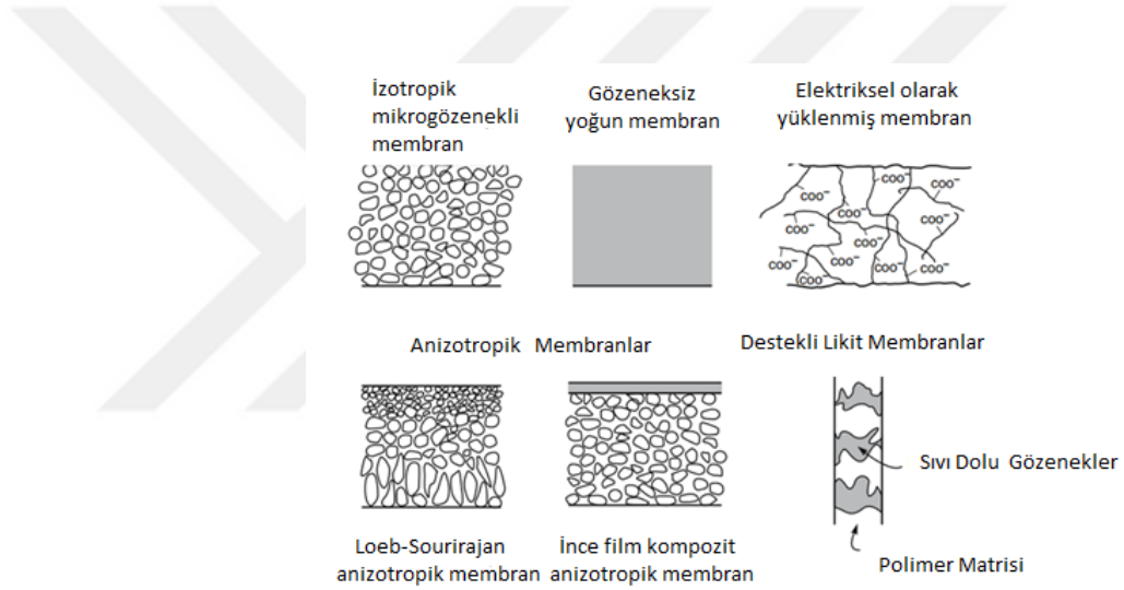
Şekil 2.1: Yapısal olarak başlıca membran tipleri [1].
