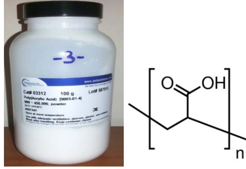
Şekil 3.6: Denemelerde kullanılan PAA ve molekül yapısı.
