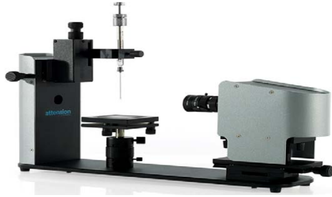
Şekil 3.11: Yüzey temas açısı cihazı
