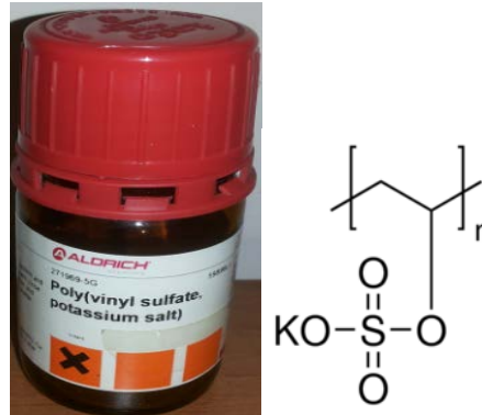
Şekil 3.5: Denemelerde kullanılan PVS ve molekül yapısı.
