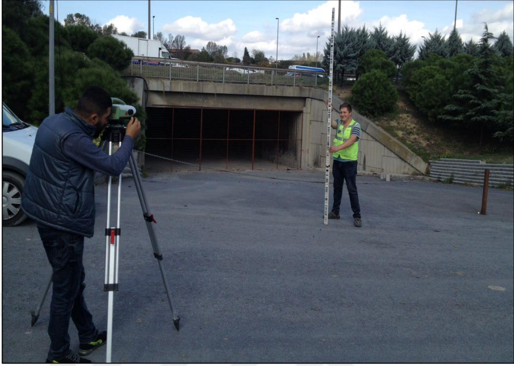
Şekil 3.6: Güzergah üzerinde bulunan yüzey otuma bulunu (SMP-Y) ölçümü.
