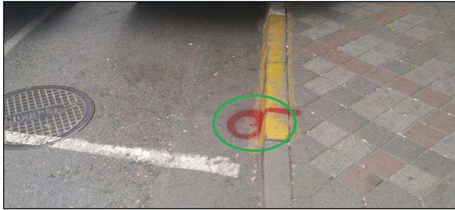
Şekil 3.5: Güzergah üzerinde asfalt üzerine yerleştirilen yüzey oturma bulonu (SMP-Y).
