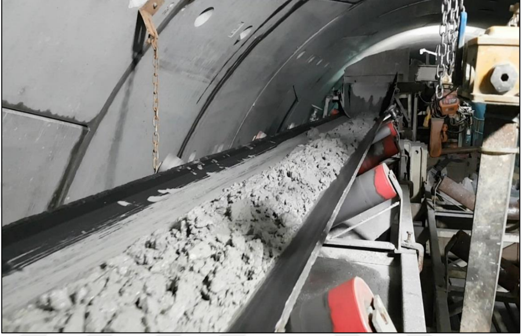
Şekil 2.4: Kazılan malzemeyi taşıyıcı vagonlara aktaran taşıyıcı bant.
