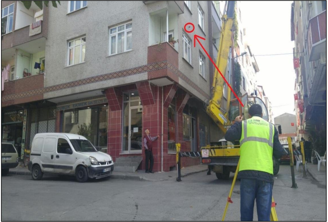
Şekil 3.7: Güzergah üzerinde bulunan binalara ait bina yatay deplasman reflektörü ölçüm noktalarının konumu.
