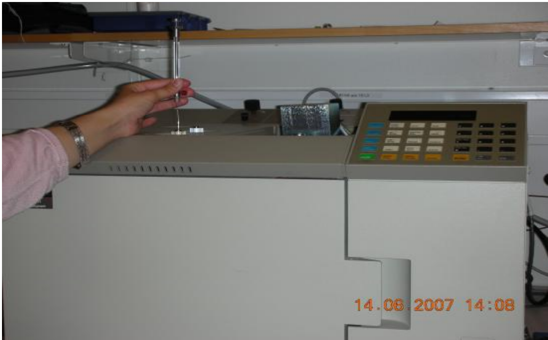
Şekil 3.18. Basıncılı iğneyle şişeden alınan metan gazının gaz kromatografi cihazıyla ölçümü
