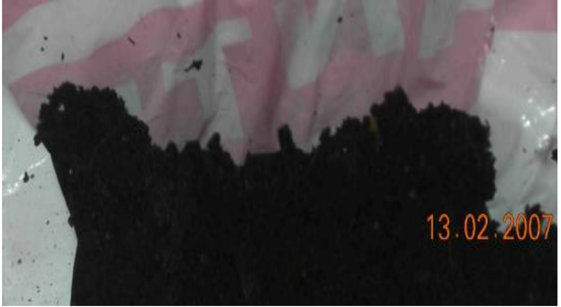
Şekil 3.11. Tesisten santrifüjden geçirildikten sonra alınan çürütülmüş çamur (Sobacken)
