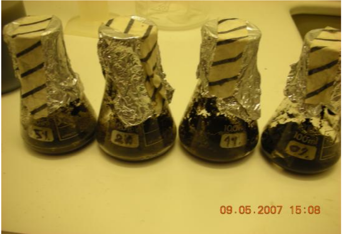
Şekil 3.16. Farklı oranlarda (% 0, % 1, % 2, % 5) sülfürik asit eklenmiş çamurlar otoklavda (121 °C'de 2 saat) bekletildikten sonra
