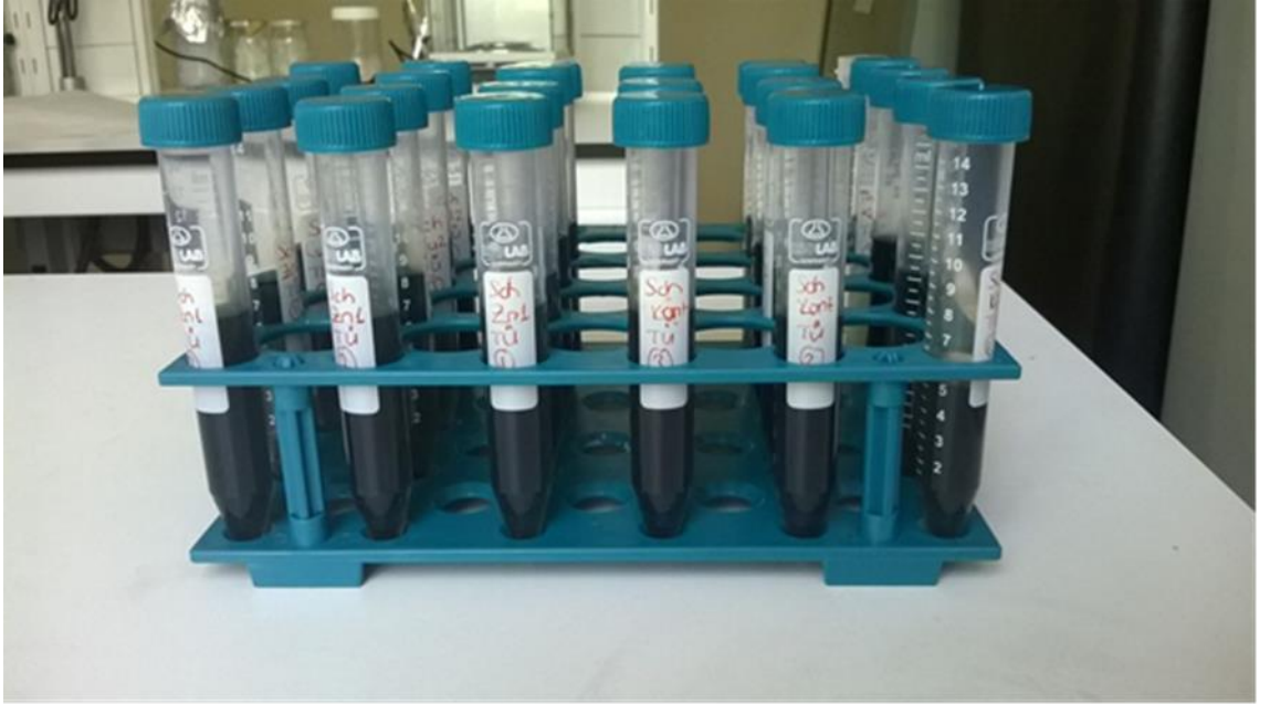
Şekil 3.23: Spektrofotometrede total fenolik madde analizi yapılmaya hazır örneklerin süpernatantları.
