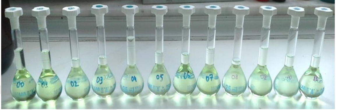
Şekil 3.19: Mikrodalgada yaş olarak yakılmış, süzölmüş, seyreltilmiş ve ICP-OES’de ağır metal ölçümlerine hazır hale getirilmiş bitki örnekleri.
