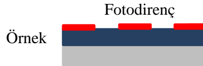
Şekil 3.12: Develop işlemi sonrası örneğin şekli.
