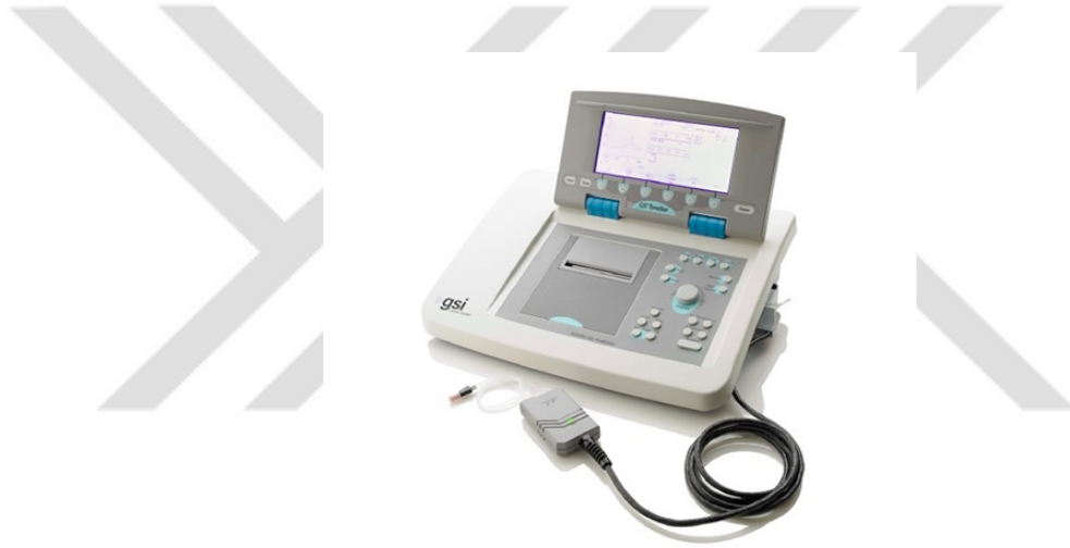
Şekil 3-1: GSI multifrekans immitansmetri.
