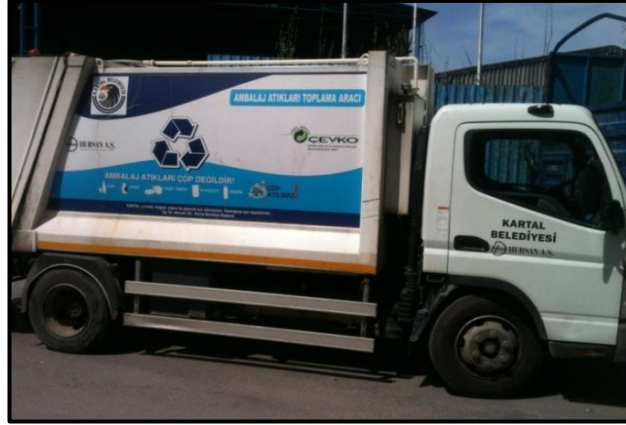
Şekil 3.11: Sıkıştırılmalı ambalaj atığı toplama aracı.
