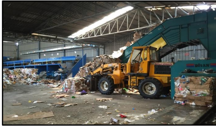
Şekil 3.19: Ambalaj atıkları presleme ve balyalama işlemi.
