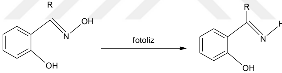
Şekil 2.39 : Ketimin oluşum reaksiyonu.
