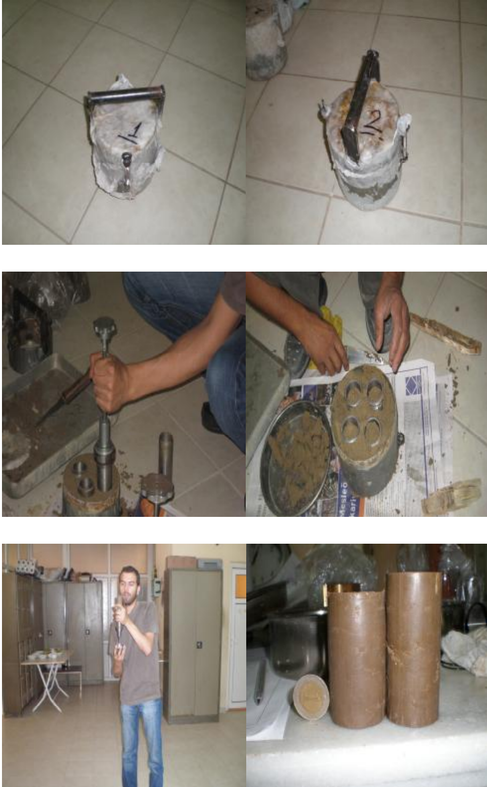
Şekil 3.8. Örselenmemiş örneklerin üç eksenli basınç deneyi için hazırlanması
