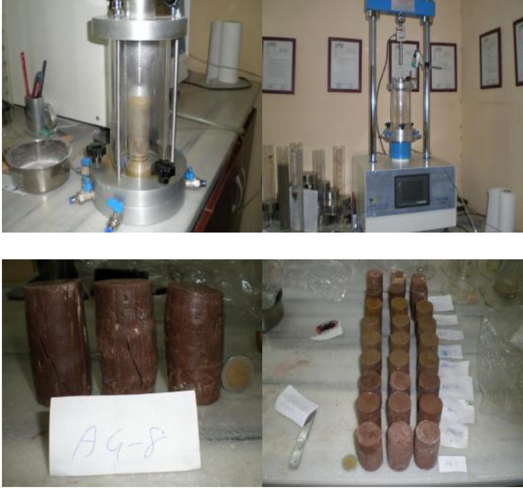
Şekil 3.9. Üç eksenli basınç deneyinin yapılışı
