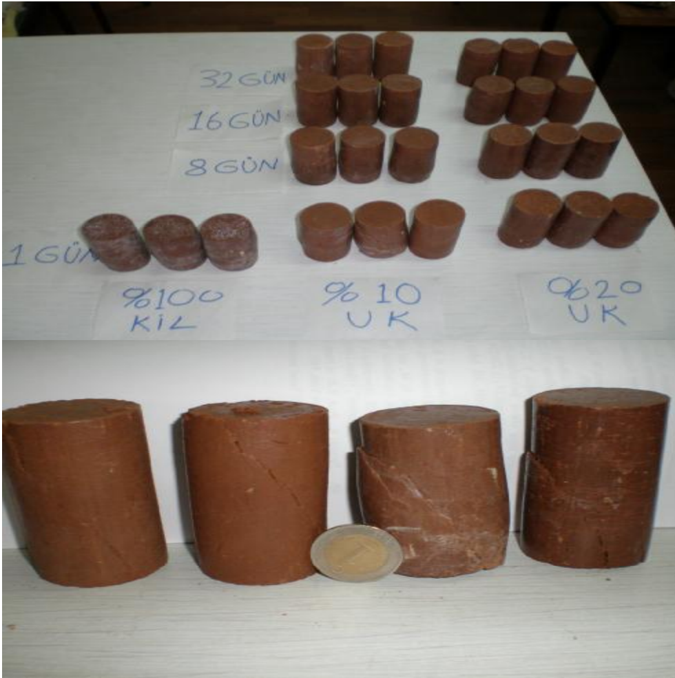
Şekil 3.15. Üç eksenli deneyi sonrası örneklerde kırılma açısı
