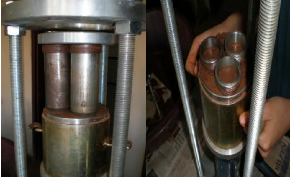
Şekil 3.9. Üç eksenli basınç deneyi için örnek alıcıların moldda yerleştirilmesi
