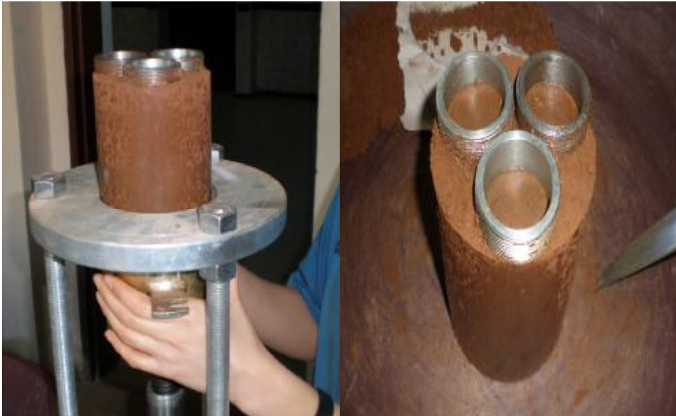
Şekil 3.10. Üç eksenli basınç deneyi için örnek alıcıların molddan çıkarılması
