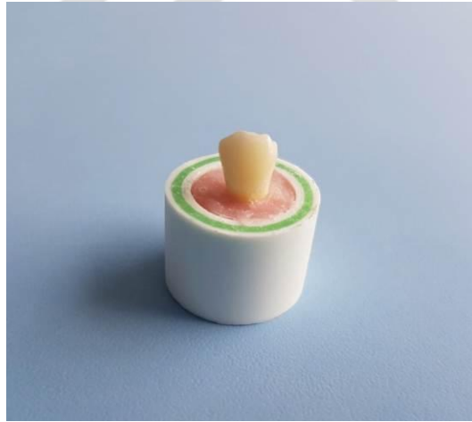
Şekil 3-11: Dişlerin kural kısımları açıkta kalacak şekilde ve mine-sement birleşiminin 2 mm apikaline kadar akrilik reçine içine gömülmesi.
