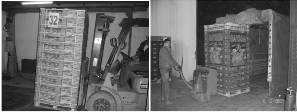
Şekil 4.18. Arabalı ve Elle Kumanda Edilen Akülü Forkliftler
