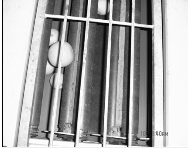
Şekil 4.9. Aralıkları Deęişen Tamburlu Tip Sınıflandırma Sistemi
