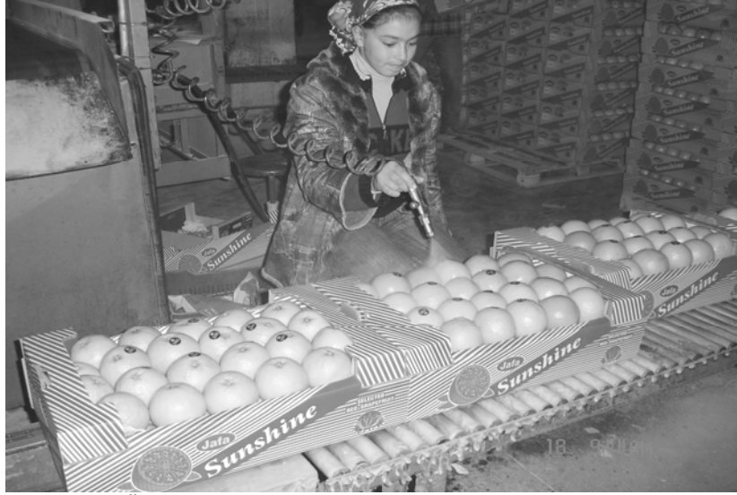
Şekil 4.13. Üstteki Meyvelerin Tekrar Mumlanarak Parlatılması
