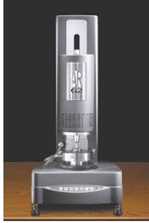
Şekil 3.5: Tez çalışmasında kullanılan AR-G2 Reometre ve çelik-cam plate.
