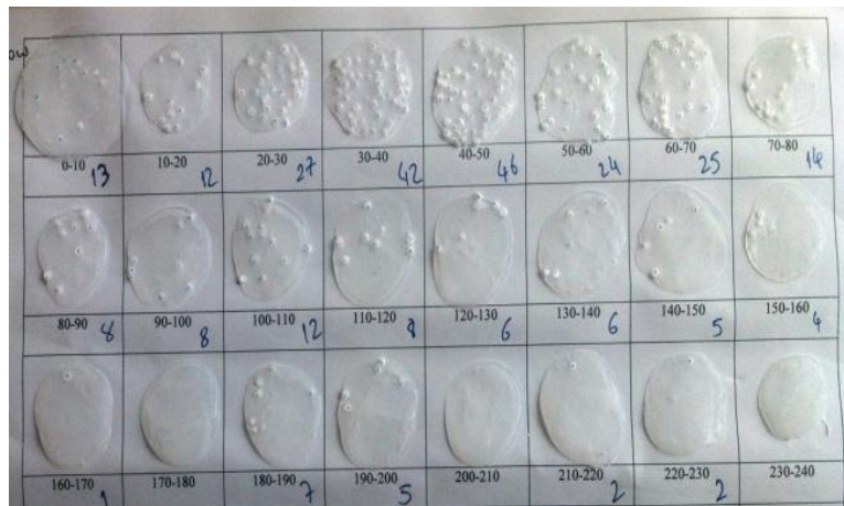
Şekil 3.7: Kalma zamanı dağılımını hesaplamak için sıcak pres ile film haline getirilmiş numuneler.
