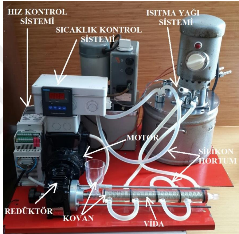
Şekil 3.2: Transparan cam kovandan oluşan tek vidalı ekstrüder düzeneği.
