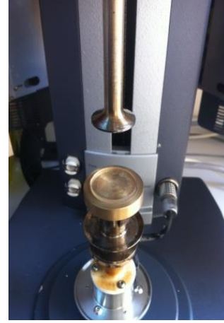
Şekil 3.5: Tez çalışmasında kullanılan AR-G2 Reometre ve çelik-cam plate.
