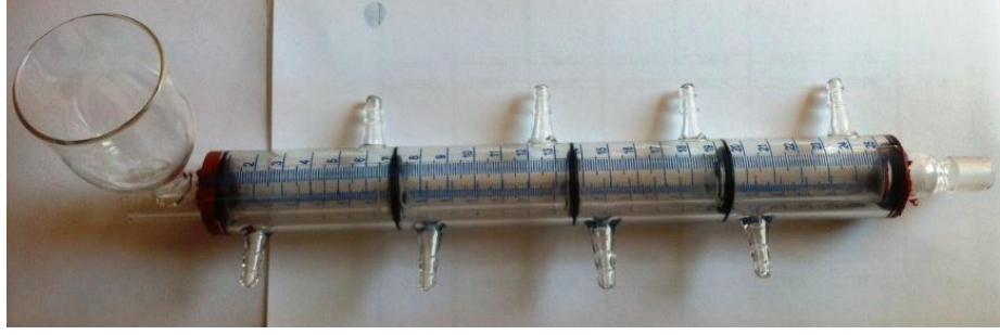
Şekil 3.3: Kullanılan tek vidalı ekstrüderin şeffaf cam kovanı.
