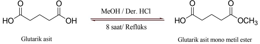
Şekil 3.4: Glutarik asit mono metil esterinin sentez reaksiyonu.
