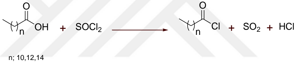
Şekil 3.7: Uzun karbon zincirli asit klorürlerin genel sentez reaksiyonu.
