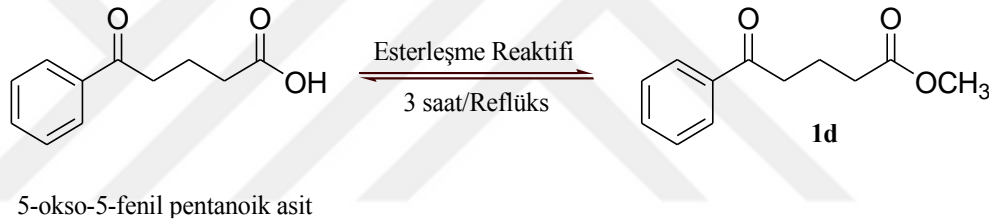
Şekil 3.1: δ-keto esterin esterleşme reaktifi ile sentez reaksiyonu.
