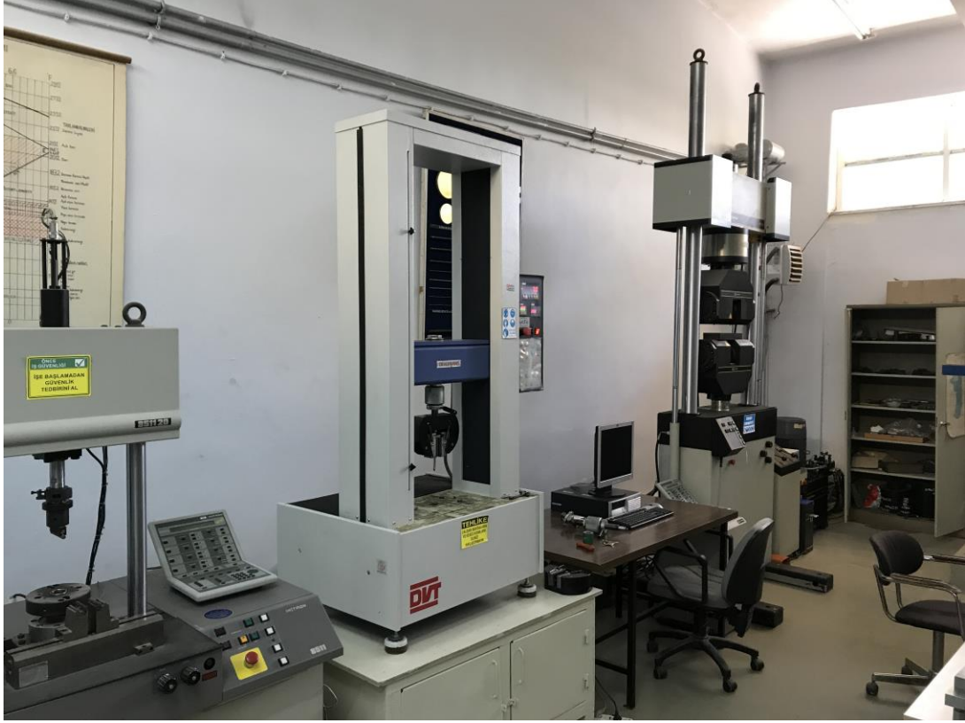
Şekil 3-20: Üniversal test cihazı görüntüsü (Devotrans, D.V.T, İstanbul, Türkiye)
