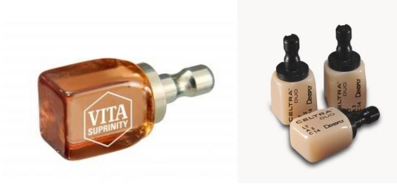
Şekil 2-4: Zirkonya ile güçlendirilmiş lityum disilikat esaslı cam seramik blok örnekleri ( görsel internetten alınmıştır)
