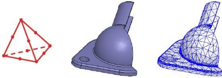
Şekil 3.4: FEM analizi için tetrahedral elemanlar ile ağa bölünmüş örnek bir yapı.
