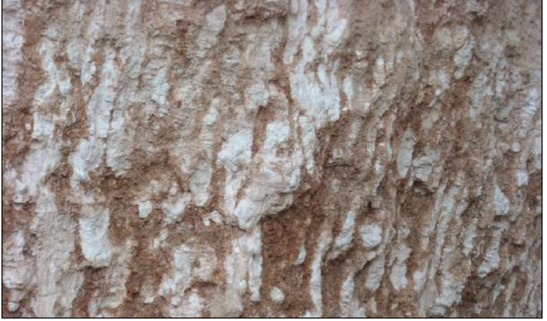
Şekil 4.9. İnceleme alanında kaliçi birimlerde kalker yumrular ve çökelim evresinden kaynaklı düşey kolonumsu oluşumları
