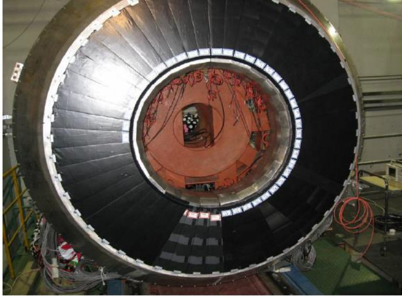
Şekil 2.8: ZKO uç kapak kısmı sintilatörlerin yerleşimi [32].
