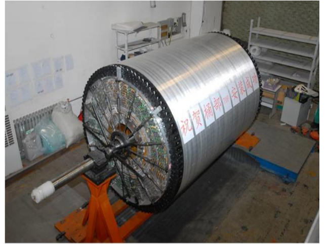
Şekil 2.7: ZKO benzetim (sol) ve kurulum öncesi görüntüsü (sağ). Fıçı kısmına yerleştirilmiş çift katman sintilatörler sağdaki resimde görülmektedir [32].
