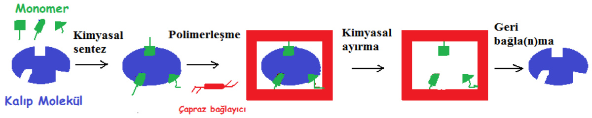
Şekil 2.2: Kovalent hafızalandırma yönteminin genel şeması.
