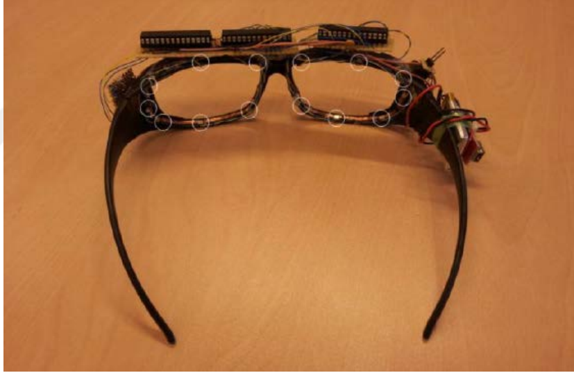
Şekil 2.2: Led göstergeli yön bulma gözlüğü [15].
