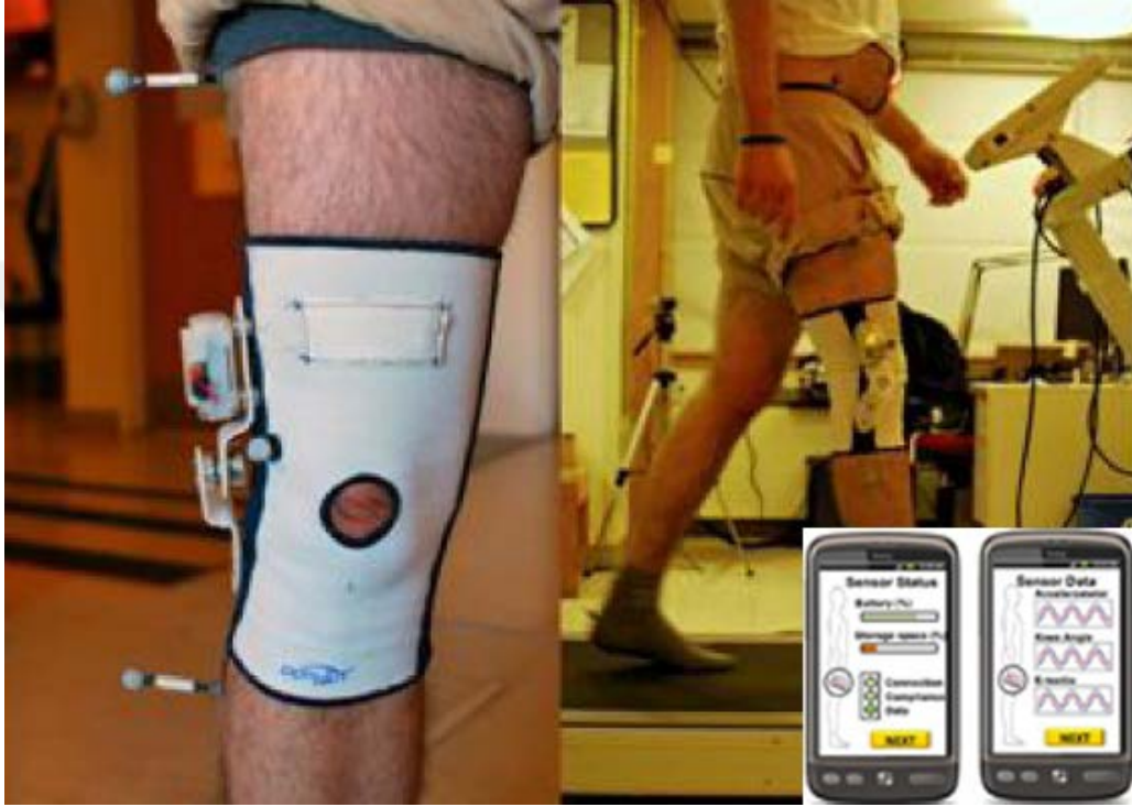
Şekil 2.3: Diz kinematiği ölçümü için geliştirilen giyilebilir sistem [18].
