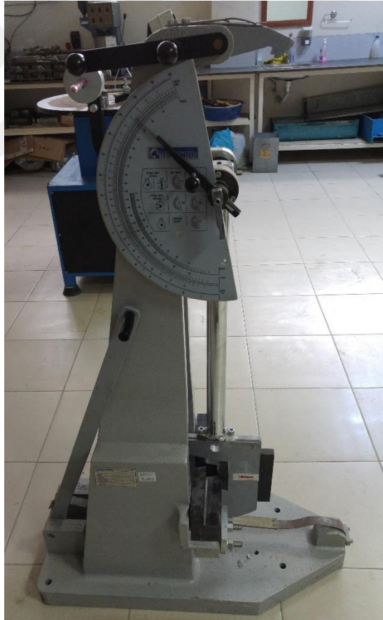
Şekil 3.6: Charpy darbe deneylerinin yapılmasında kullanılan Testcenter marka cihaz.
