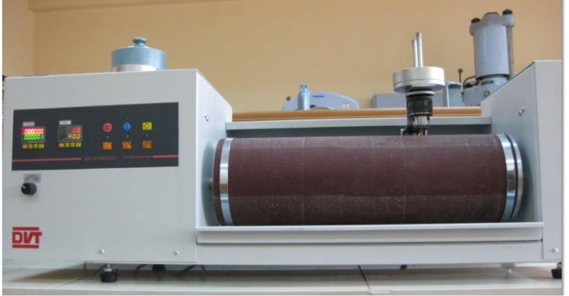
Şekil 3.7: Aşınma deneylerinin yapılmasında kullanılan Devotrans marka aşındırma deney cihazı.
