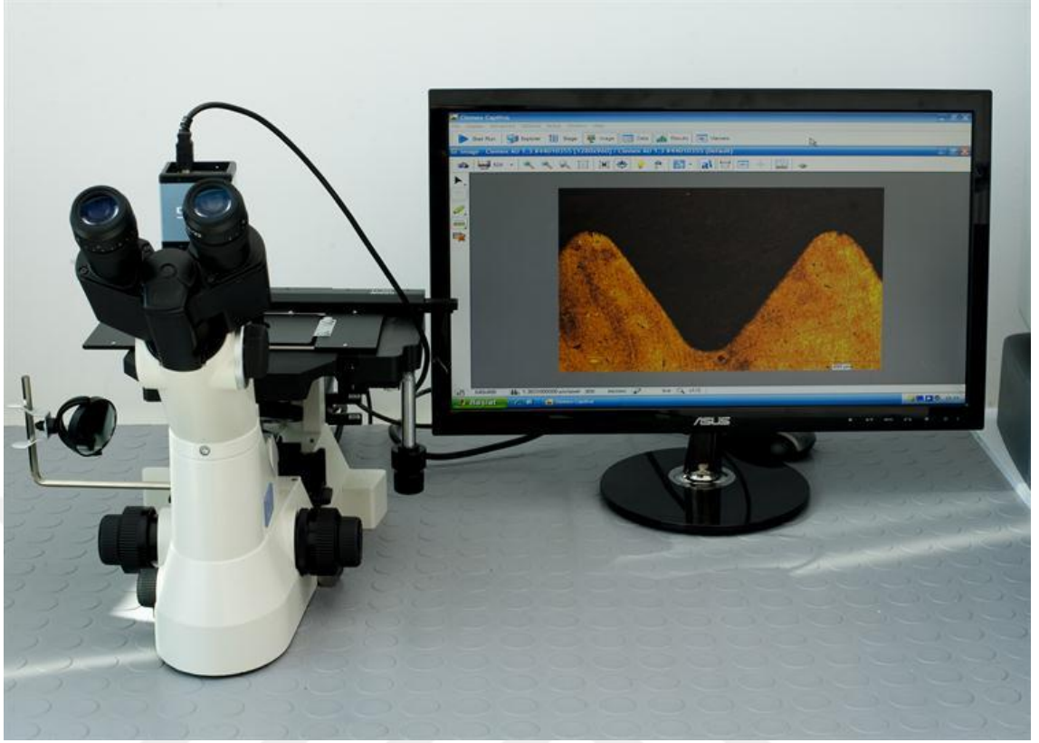
Şekil 3.1: Malzemelerin mikroyapılarının fotoğraflanmasında kullanılan Nikon marka mikroskop. 1
