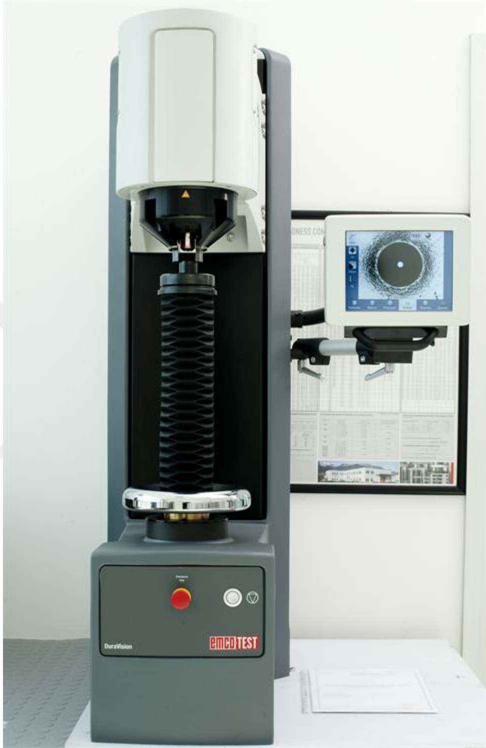
Şekil 3.2: Malzemelerin sertliklerinin ölçülmesinde kullanılan Emcotest marka Brinell – Vickers – Rockwell sertlik ölçüm cihazı. 1
