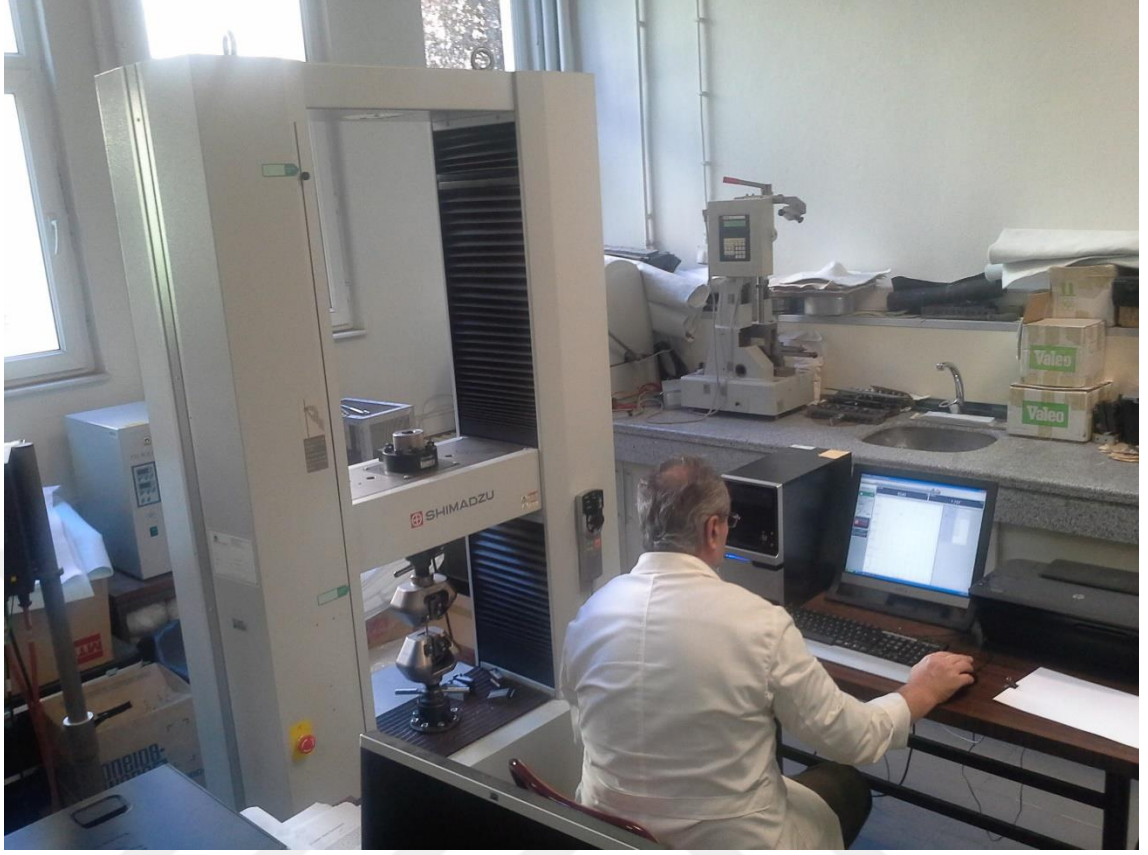
Şekil 3.4: Çekme deneylerinin yapılmasında kullanılan Shimadzu marka üniversal çekme cihazı.
